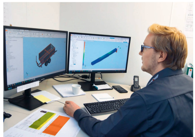
Dans le projet de Sven Baeriswyl, il y a une remorque télescopique. Les données du timon sont calculées sur l'écran de droite.
