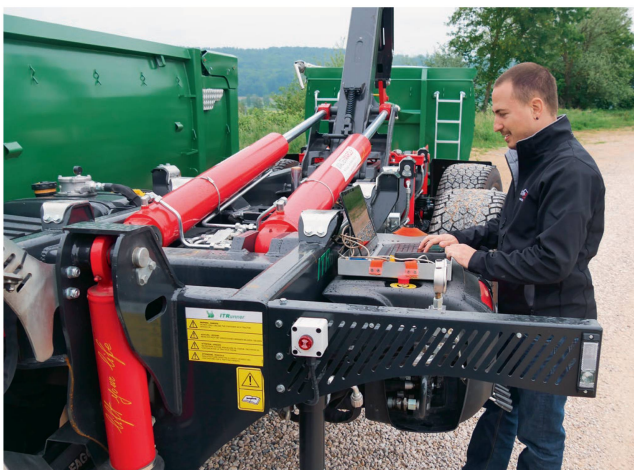
Jean-Philippe Mergel programme l'électronique d'un porte-caissons avec deux essieux directeurs.
