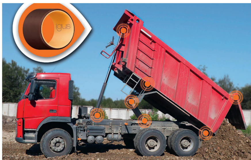
Les paliers lisses en polymère sans lubrifiants sont également utilisés sur les machines lourdes. Ils sont protégés par une coque extérieure en polymère dur.
