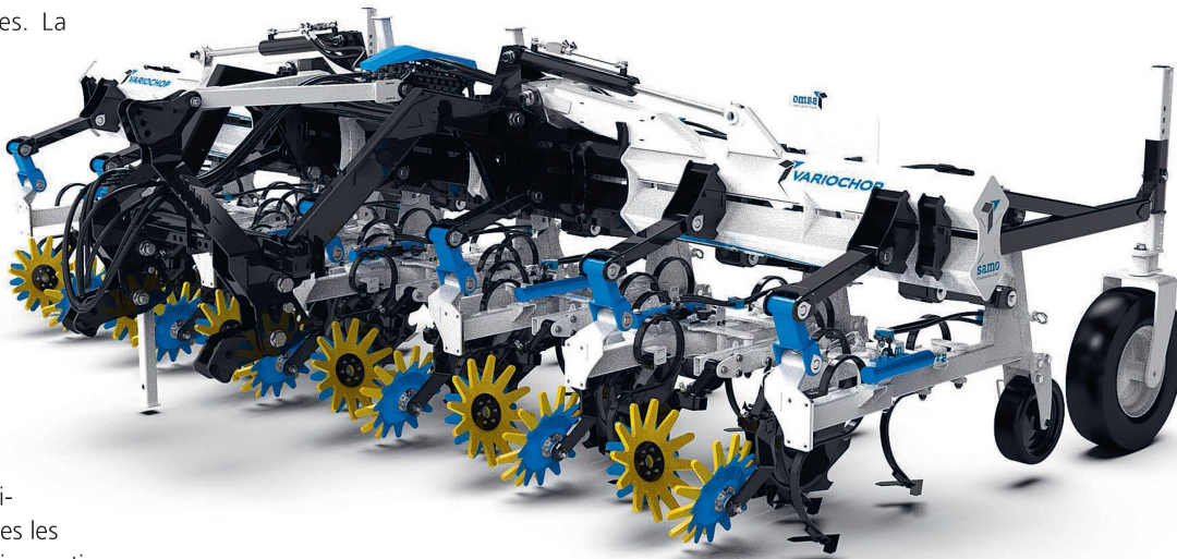
Avec cette sarcleuse, l'espacement entre les rangs se règle hydrauliquement depuis la cabine du conducteur. Illustration : Samo Maschinenbau
