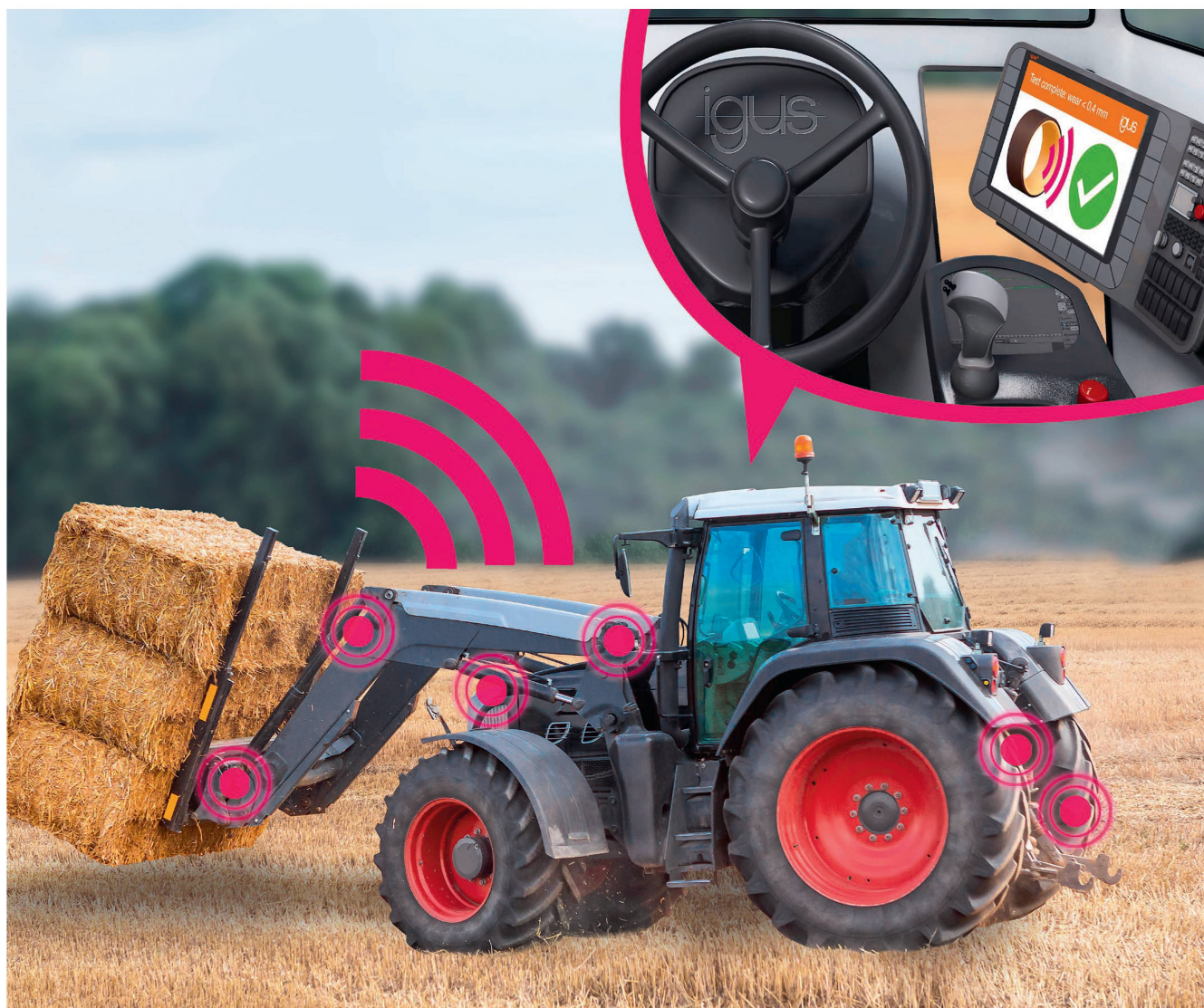
Construit par Igus en polymère haute performance Iglidur, le premier palier intelligent détecte l'usure et avertit en cas de risque de rupture.
