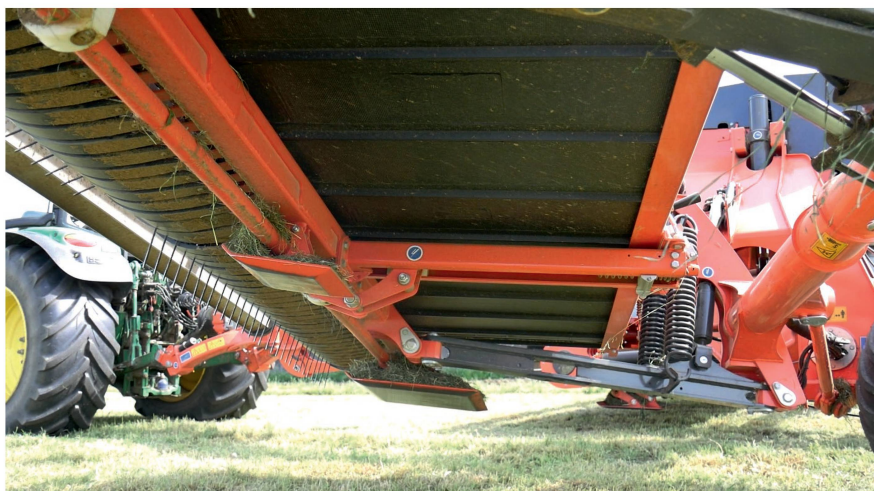
Quatre patins assurent le suivi du sol et le réglage de la hauteur de travail.
