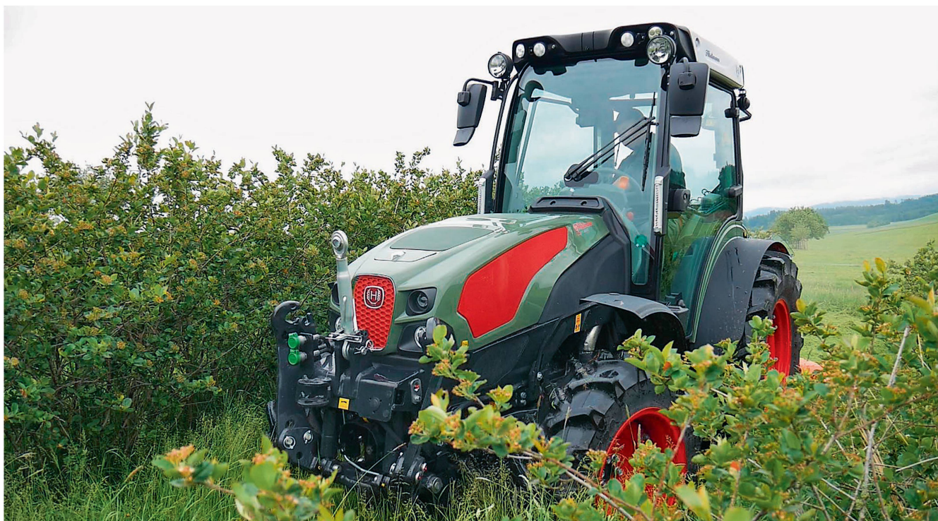
Le tracteur à voie étroite Hürlimann «XF 115 V-Drive» à quatre roues directrices et suspension avant comporte une cabine sans tunnel et des portes à ouvertures très larges. Photos : Martin Abderhalden et Roman Engeler
