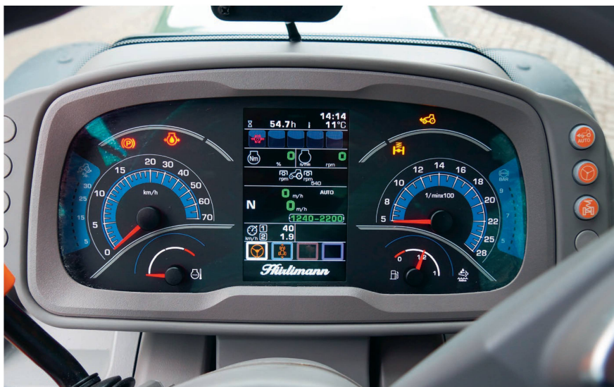
L'«InfoCenterPro» de 5 pouces entre les cadrans fournit des informations sur l'ensemble du fonctionnement du tracteur et permet de procéder à divers réglages.
