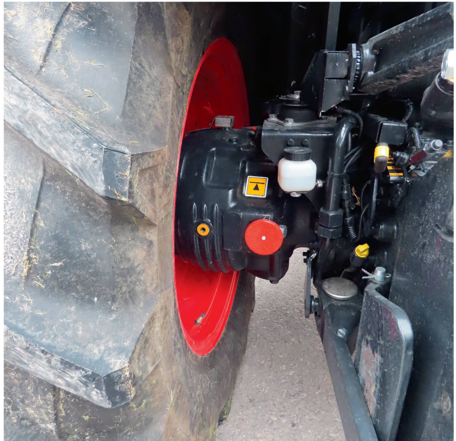
L'essieu arrière peut atteindre un angle de braquage de 18 degrés.
