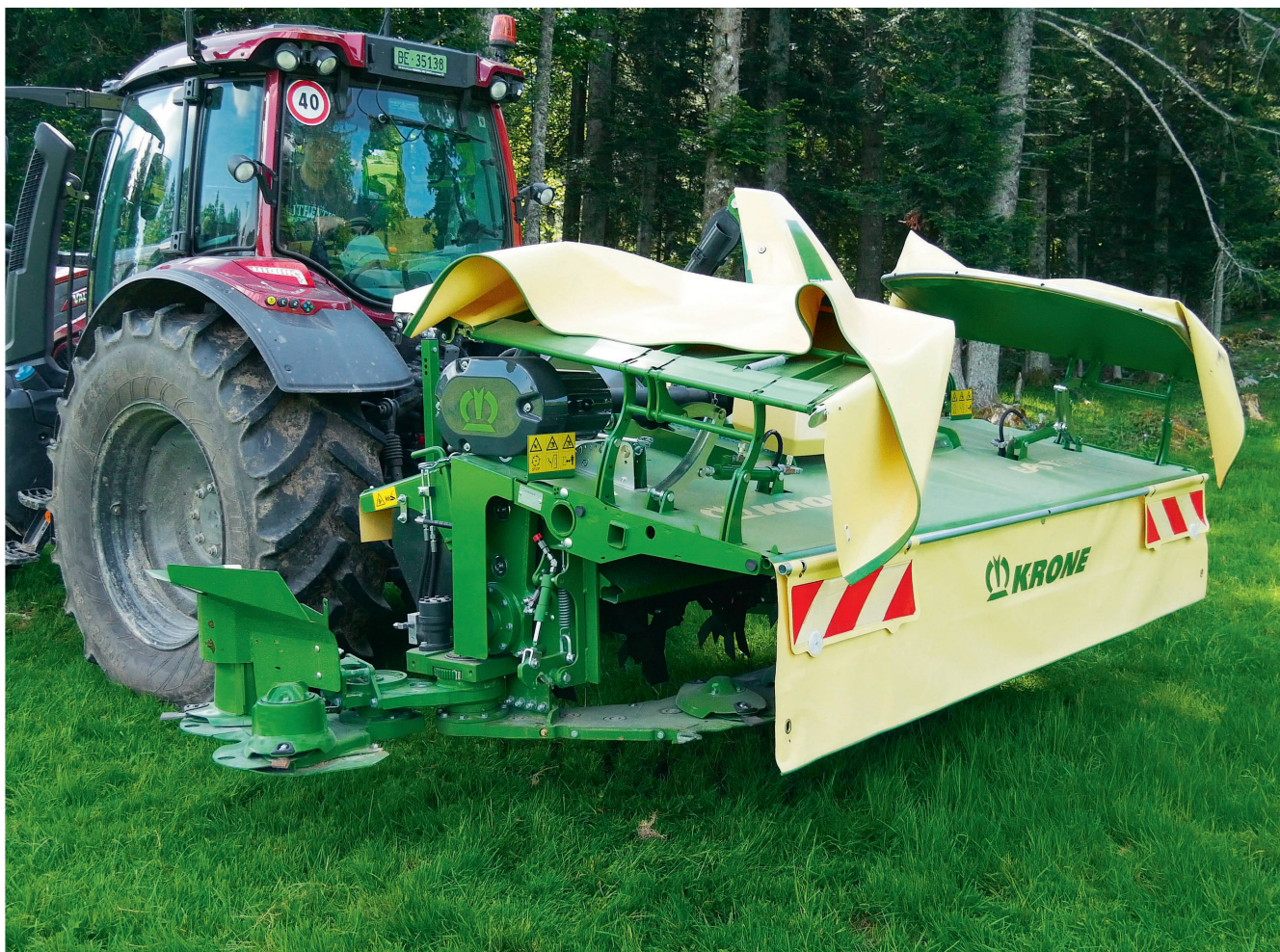
Pour circuler sur la route, les deux tambours extérieurs s'escamotent au moyen d'un système hydraulique entre les roues du tracteur et le bâti de la faucheuse. Les protections latérales se rabattent sur la machine. Photos: Heinz Röthlisberger
