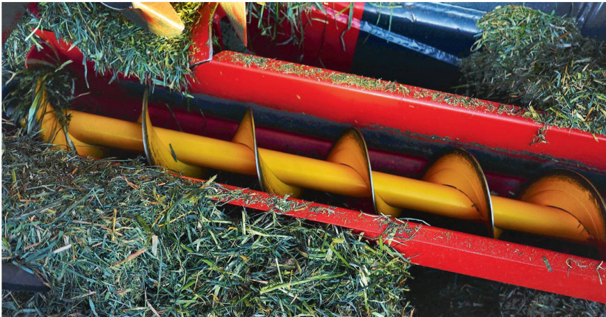
Les chutes de fourrage sont récupérées sur un plancher avec convoyeur à barettes puis réacheminées vers le tapis d'alimentation au moyen de deux vis sans fin.
