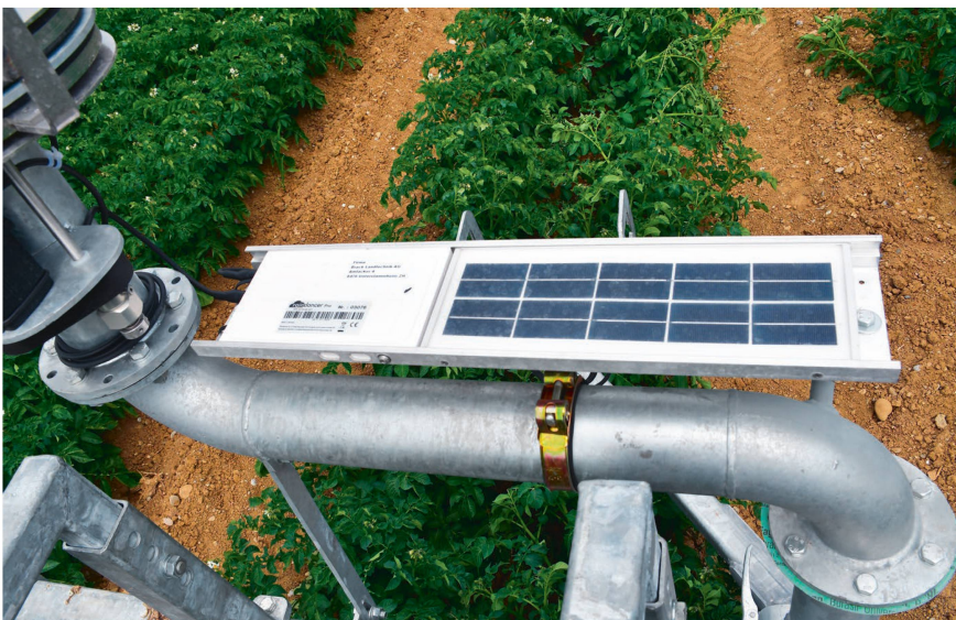
Le récepteur GPS et son module d'alimentation solaire, ainsi qu'un capteur de pression sont montés sur le chariot d'arrosage.
