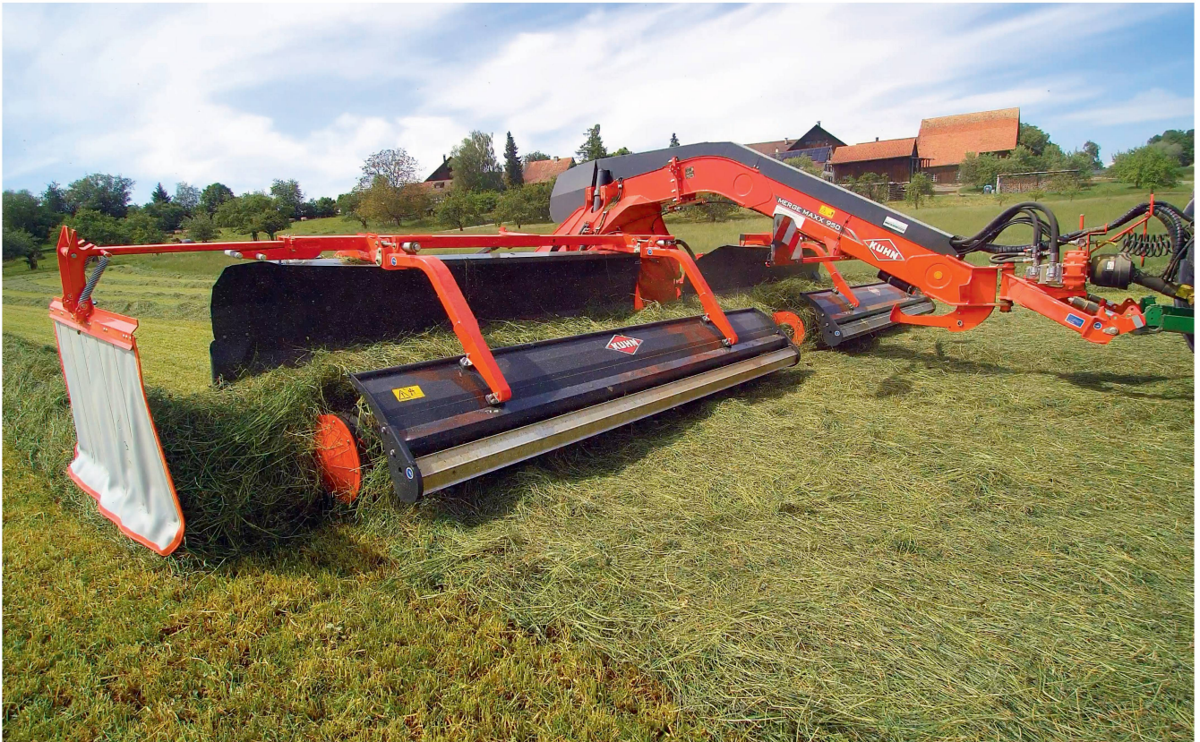
Les andaineurs à tapis de Kuhn sont dotés d'un pare-vent à rouleau associé à une tôle de guidage incurvée qui doivent assurer un flux de fourrage optimal et limiter les pertes. Photos: Roman Engeler
