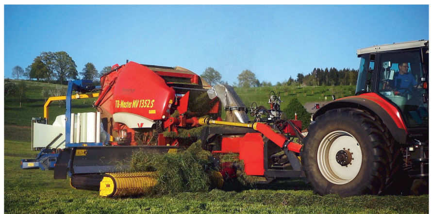
La boîte de distribution répartit la puissance du tracteur entre l'ensileuse, la presse et l'hydraulique embarquée pour actionner l'andaineur à tapis.
