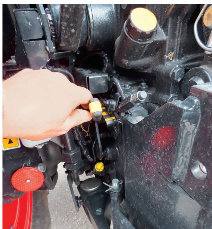
Le régime de prise de force doit être sélectionné de l'extérieur, à l'arrière du véhicule.
