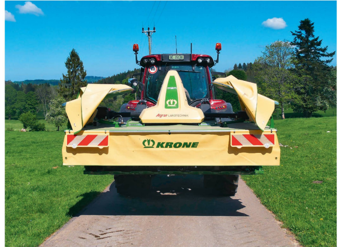
À gauche, la faucheuse déployée sur la prairie. À droite, en configuration route, de 3 mètres de large.
