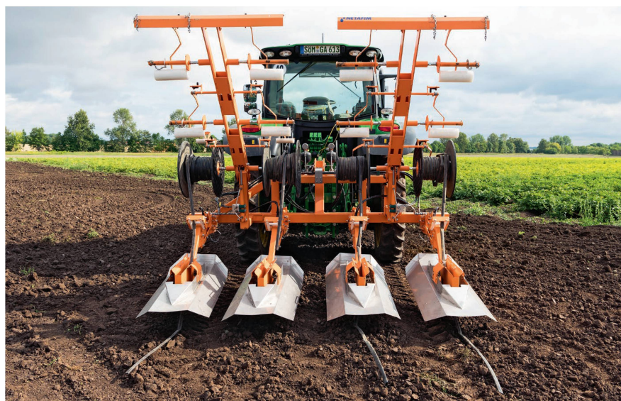
La machine de pose et de récupération des tuyaux goutteurs existe en version à quatre et six rangs. Les socs sont mobiles et s'adaptent aux écarts de largeur de rang.
