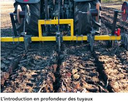
L'introduction en profondeur des tuyaux pour l'arrosage goutte-à-goutte, par exemple de cultures de plantes vivaces, se fait au moyen d'une charrue, ici un modèle à cinq rangs. Photo: Eisenhut/Netafim
