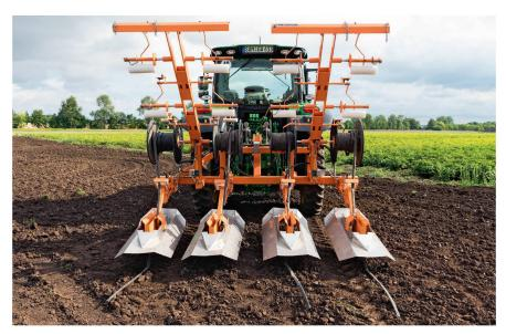
La machine de pose et de récupération des tuyaux goutteurs existe en version à quatre et six rangs. Les socs sont mobiles et s'adaptent aux écarts de largeur de rang.
