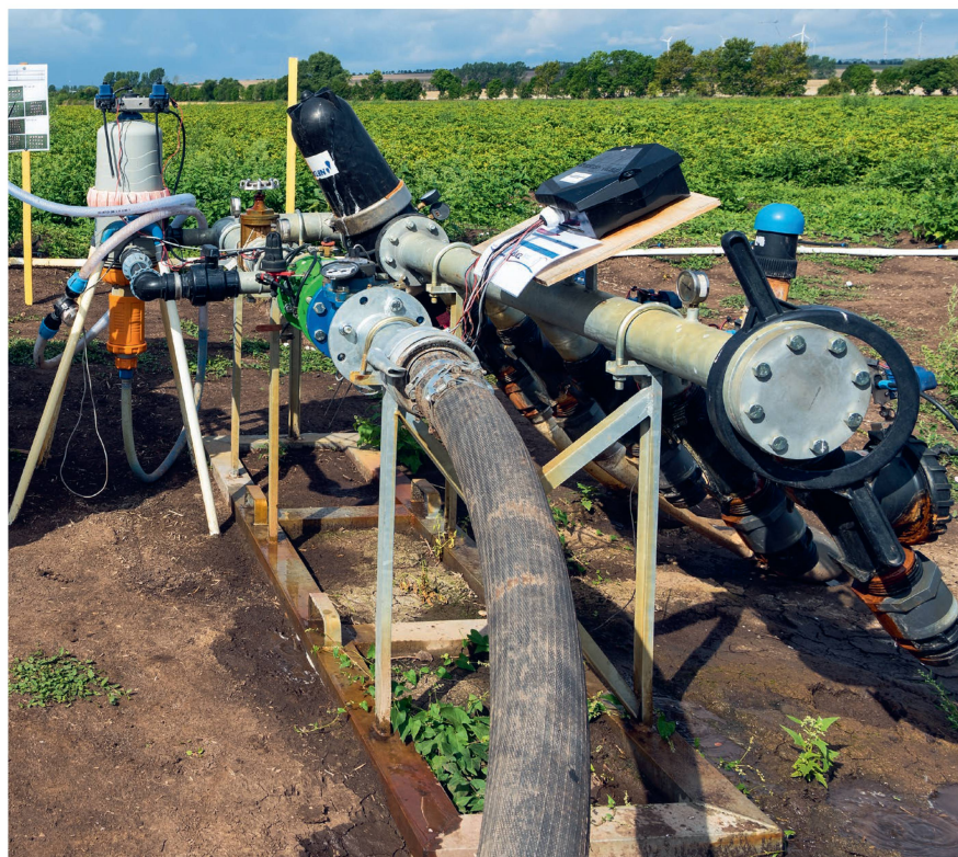
La station d'alimentation de l'arrosage goutte-à-goutte Netafim est équipée d'un incorporateur de fertilisant, d'un filtre, d'un réducteur de pression et d'unités d'automatisation.
