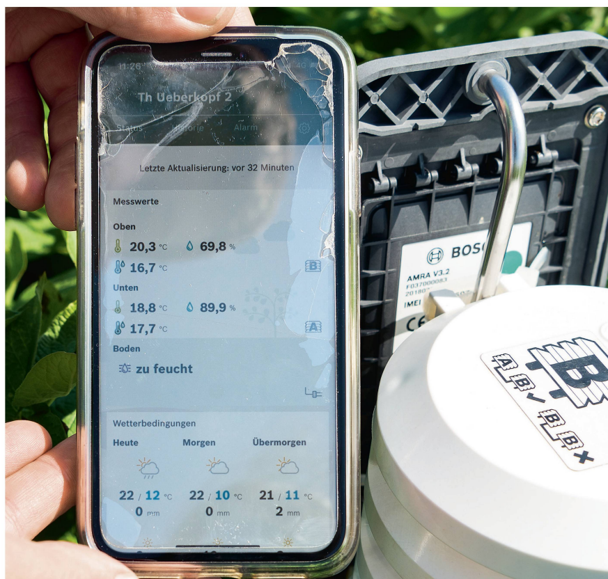
Pour la surveillance des champs, les valeurs d'humidité du sol et de l'air, ainsi que la température, sont affichées sur le smartphone au moyen de l'application « Deepfield Connect ».
