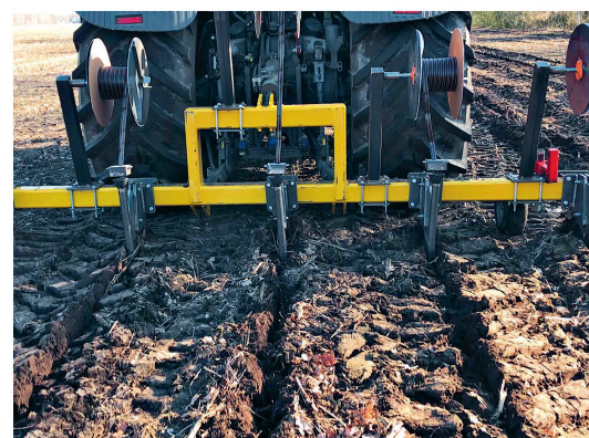
L'introduction en profondeur des tuyaux pour l'arrosage goutte-à-goutte, par exemple de cultures de plantes vivaces, se fait au moyen d'une charrue, ici un modèle à cinq rangs. Photo : Eisenhut/Netafim
