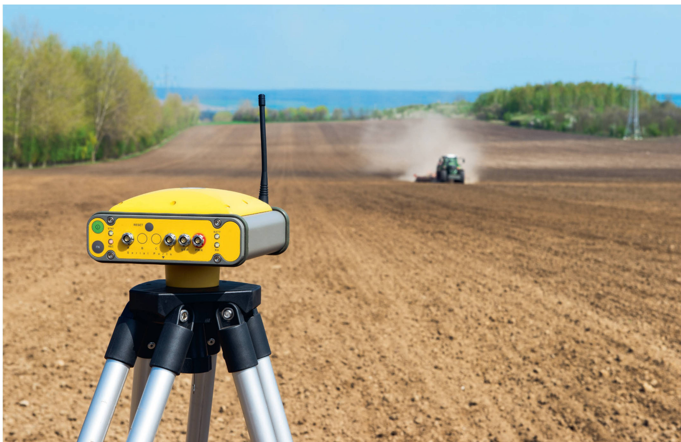
Les systèmes d'autoguidage et le contrôle des sections exigent des systèmes de positionnement précis par satellite et des signaux de correction RTK. Photo : ldd
