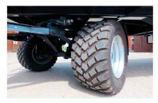
Une solide direction à tourelle, des essieux avec amortisseurs et des pneus de 500: la remorque est faite pour circuler partout.
