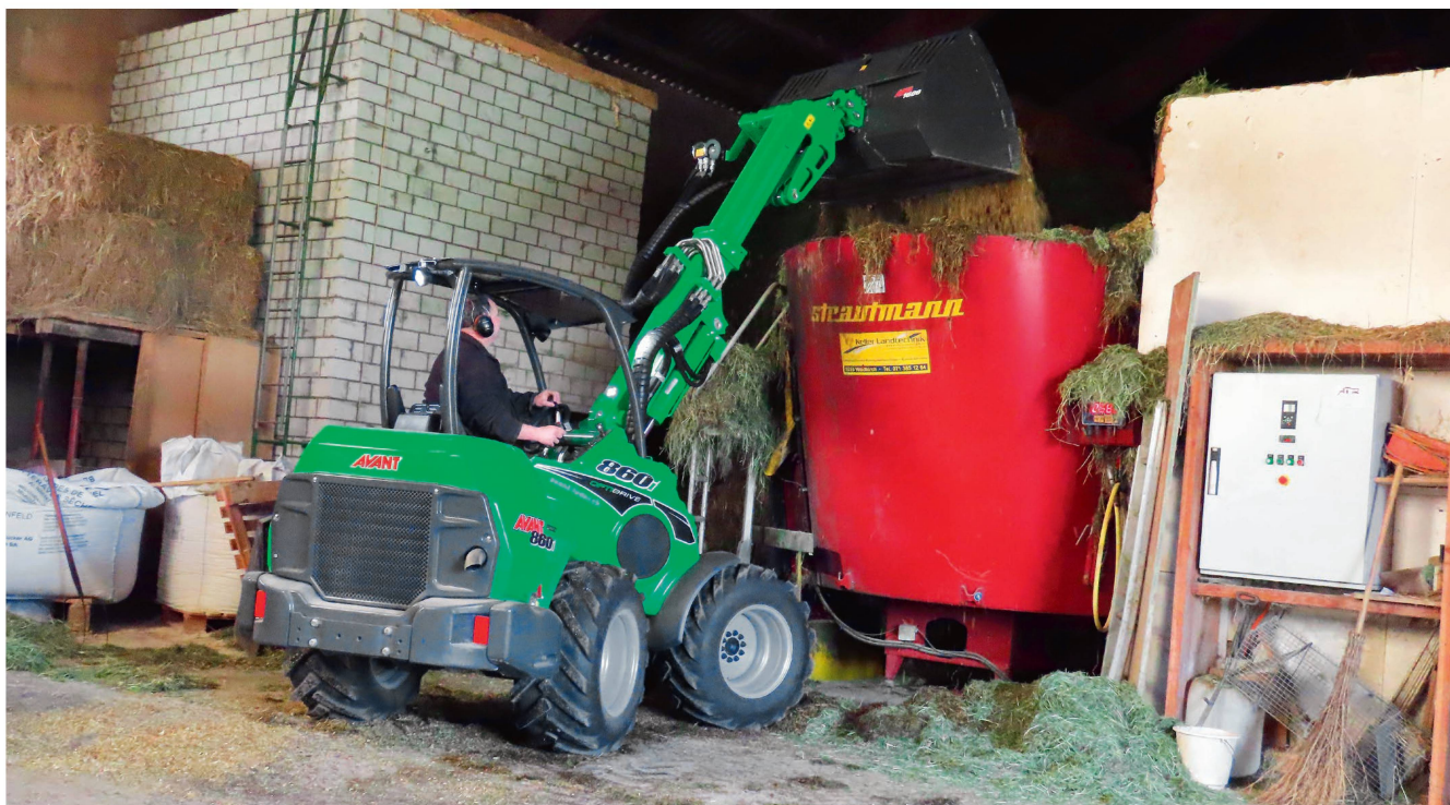
Le bras de levage télescopique de l'Avant «860i» se prête bien au chargement de contenants hauts comme cette mélangeuse stationnaire de fourrage. Photos: Martin Abderhalden
