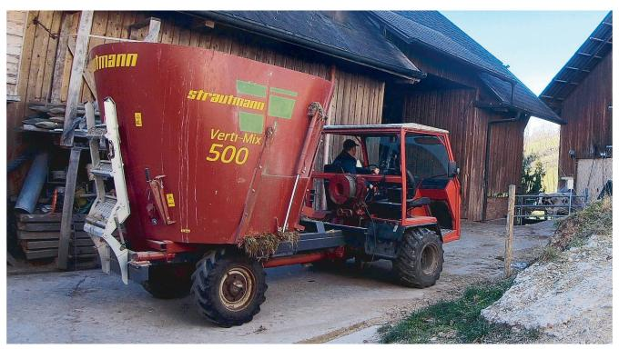
Transformé en mélangeuse automotrice, le transporter se laisse facilement manœuvrer dans les passages étroits. Photos: Ruedi Burkhalter
