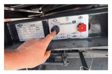
La soupape de manœuvre permet de desserrer les freins, pour autant qu'il reste de l'air comprimé dans le réservoir.
