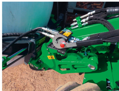
Fabriqués avec soin, les raccords rapides sur les accessoires portés ont fait leurs preuves sur le terrain.
