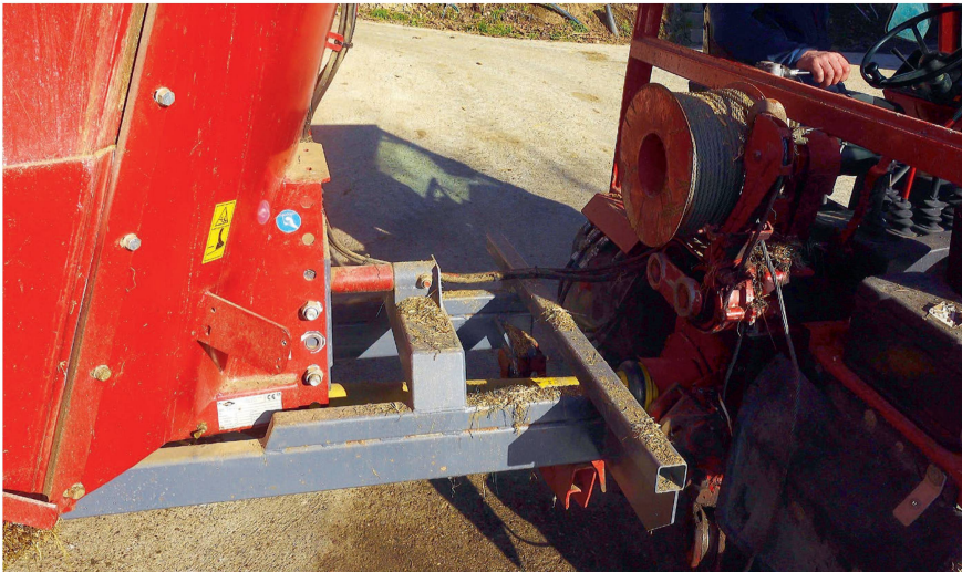
Comme toute autre superstructure, la mélangeuse est facile à monter et à démonter grâce à son cadre en acier.
