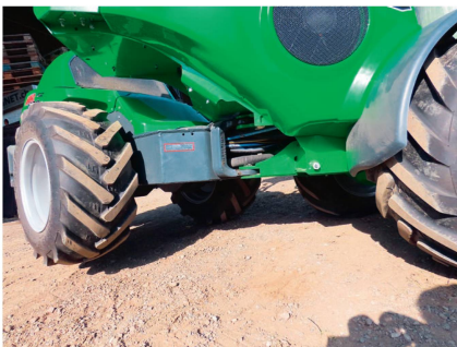
L'Avant « 860i » est très stable grâce à son bras articulé fixe, et le risque de basculement est ainsi considérablement réduit.
