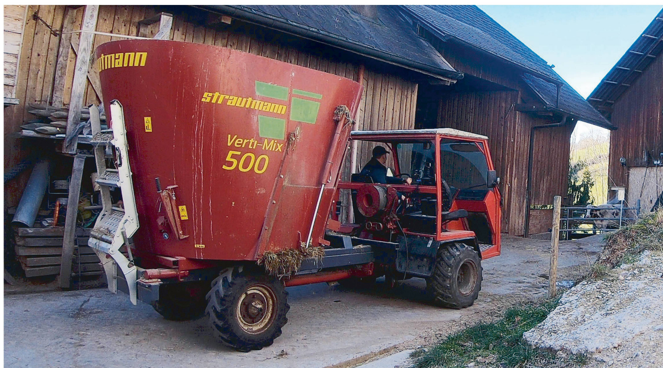
Transformé en mélangeuse automotrice, le transporter se laisse facilement manœuvrer dans les passages étroits. Photos : Ruedi Burkhalter
