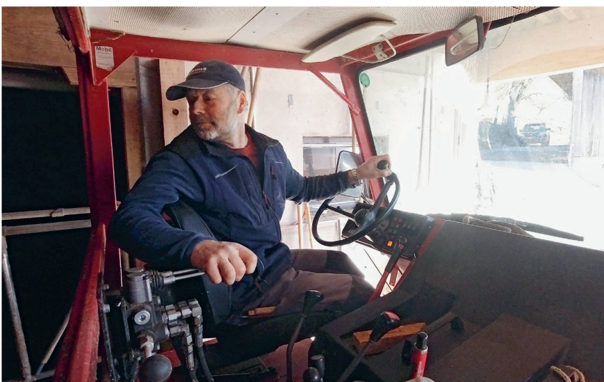
Peter Ramseier, de Linden (BE), au volant de son transporter. Un simple distributeur double effet a été installé à côté du siège du conducteur pour commander les deux trappes latérales.
