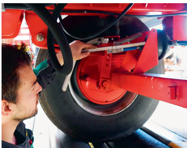
Si le cylindre pousse le piston de frein trop vers l'extérieur, c'est que les garnitures sont usées. On peut effectuer soi-même régulièrement ce genre de contrôles à la maison.
