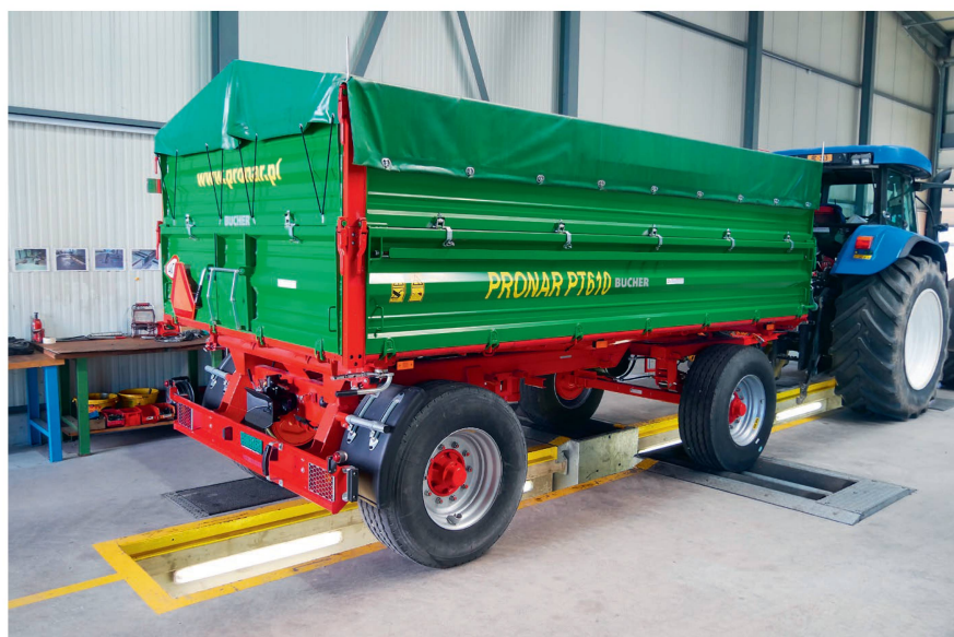
Les tests de freins au banc d'essai à rouleaux fournissent des résultats précis, dans des conditions toujours identiques.
