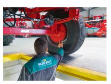
Les plaques vibrantes servent à vérifier l'état des trains roulants et, par exemple, à détecter le jeu des roulements des roues.
