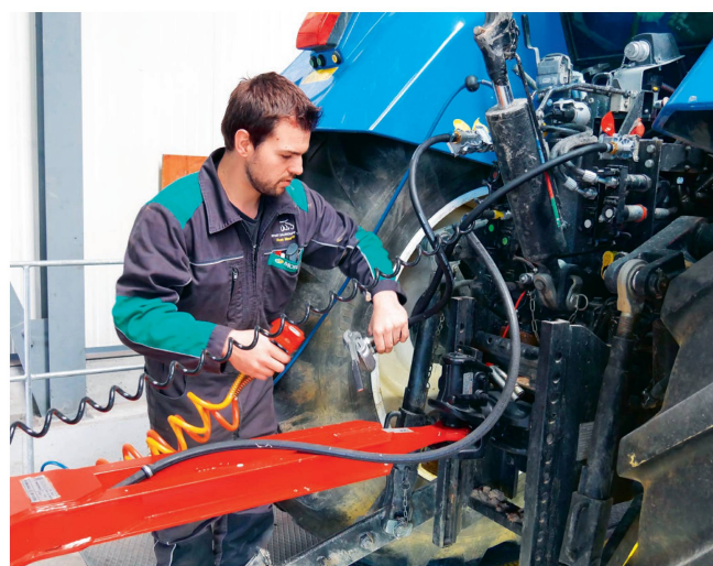
Accouplement de la conduite de frein: le client doit connaître le taux de freinage de sa remorque. S'agit-il de 38 ou de 50 % (depuis le 1 er mai 2019) du poids total ?
