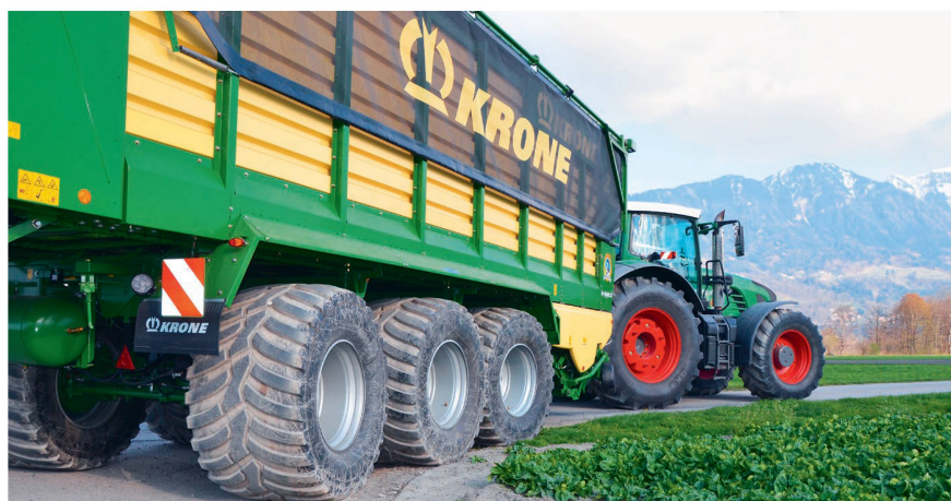
Articulé et suspendu: le châssis tridem sous cette remorque d'ensilage est idéal dans toute situation. Photo: Ruedi Hunger
