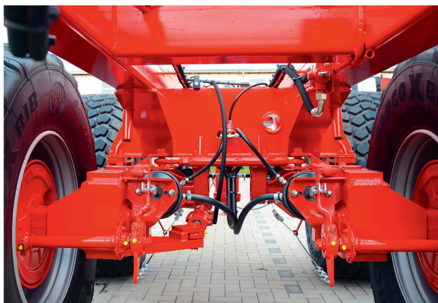
Essieux pendulaires: ce châssis permet une stricte compensation longitudinale.
