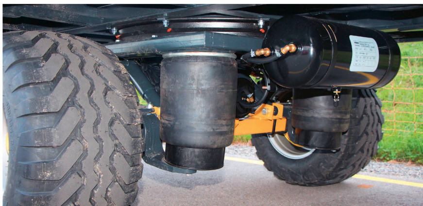
Confort optimal: une suspension pneumatique nécessite une installation d'air comprimé.
