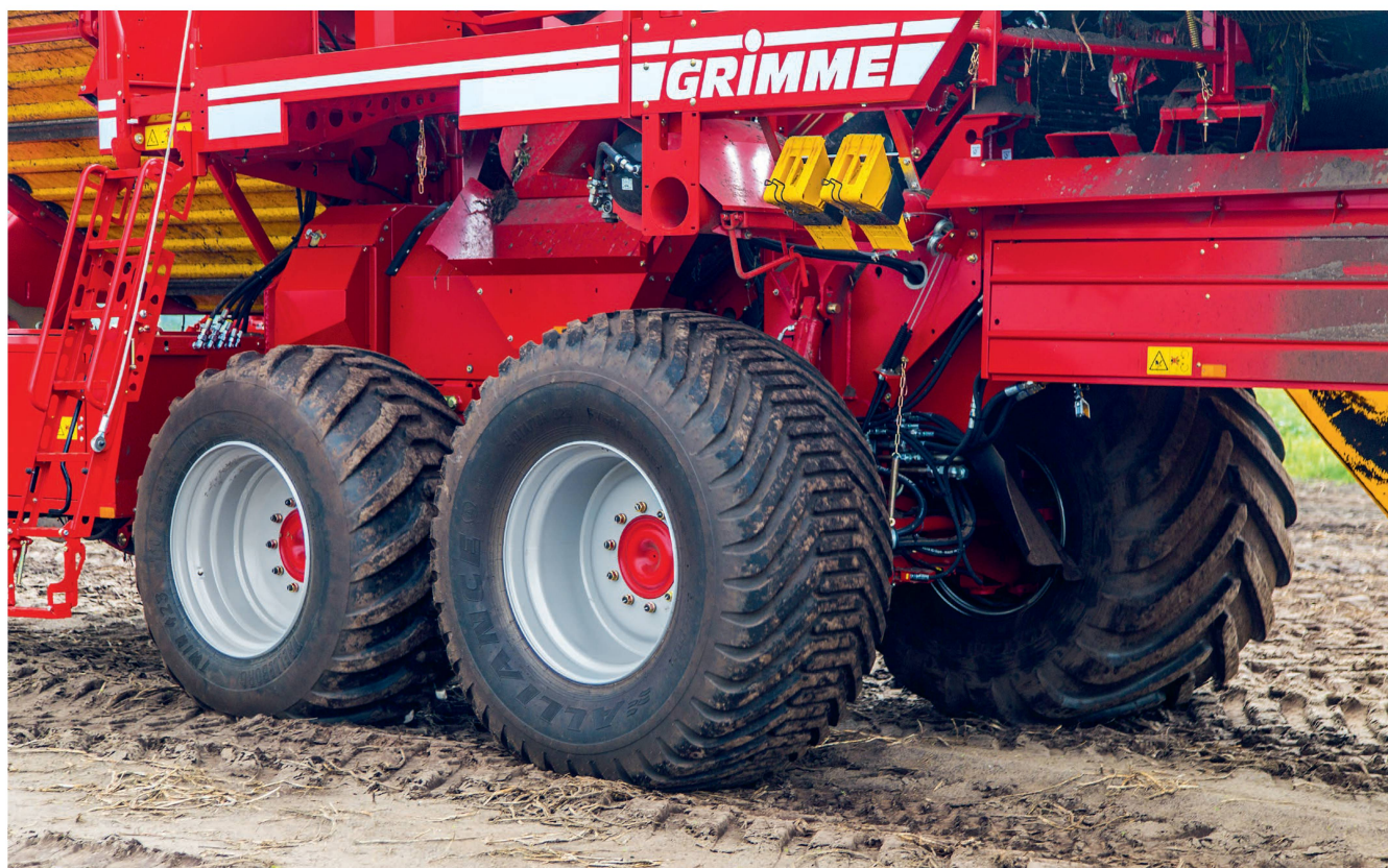
Entraînée: l'arracheuse de pommes de terre Grimme «Evo 290» est disponible en option avec des moteurs de moyeu de roue. Photo : Grimme
