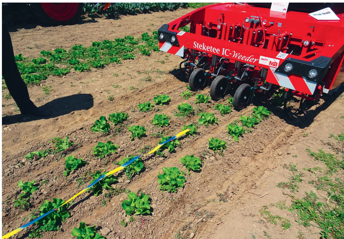
La «IC-Weeder» de Steketee sarcle sur le rang. Les couteaux de sarclage sont commandés pneumatiquement. L'outil peut encore recevoir un dispositif très précis de pulvérisation de produits phytosanitaires. Photo : Roman Engeler
