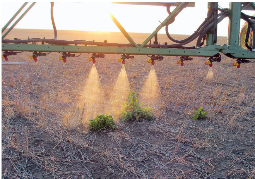
Le système utilisant des capteurs et des buses intelligentes « AmaSpot » d'Amazone permet de supprimer les applications larges. Seules les zones sur lesquelles des adventices sont présentes sont traitées. Photo : Amazone
