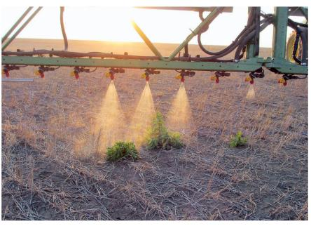
Le système utilisant des capteurs et des buses intelligents «AmaSpot» d'Amazone permet de supprimer les applications larges. Seules les zones sur lesquelles des adventices sont présentes sont traitées. Photo: Amazone
