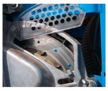
Sur le côté droit, on peut surveiller l'occupation des cellules de prélèvement au travers d'une fenêtre en plexiglas.
