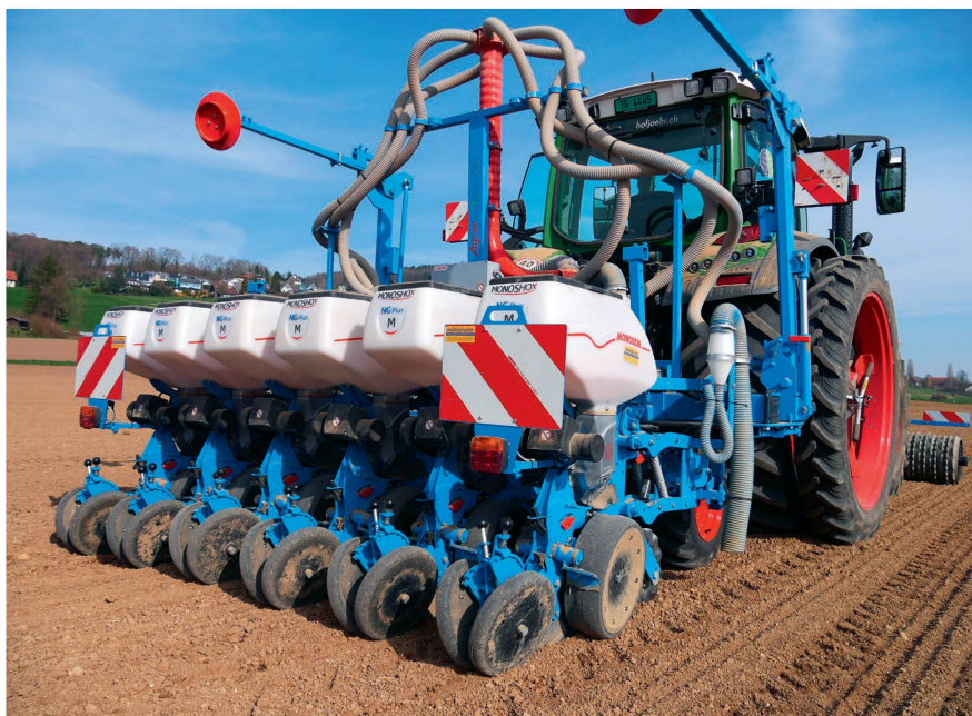
Le semoir monograin « Monoshox NG Plus ME Extend » au semis de betteraves sucrières. La vitesse de travail est de 7 km/h. Photos : Roman Engeler
