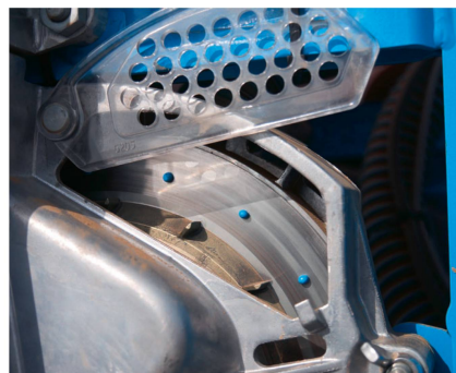
Sur le côté droit, on peut surveiller l'occupation des cellules de prélèvement à travers d'une fenêtre en plexiglas.
