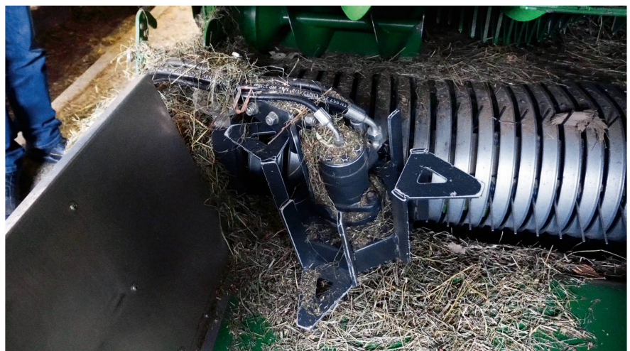
À l'entrée du pick-up, les «speed drums» régularisent l'alimentation de la presse.
