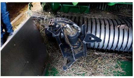
À l'entrée du pick-up, les «speed drums» régularisent l'alimentation de la presse.
