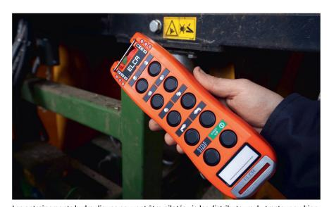
Les entraînements hydrauliques peuvent être pilotés via les distributeurs du tracteur ou bien, sur la version illustrée ici, au moyen d'une télécommande.
