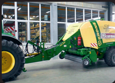
Le montage et la fixation avec des broches prend une quinzaine de minutes.
