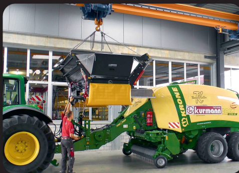
Le montage et la fixation avec des broches prend une quinzaine de minutes.
