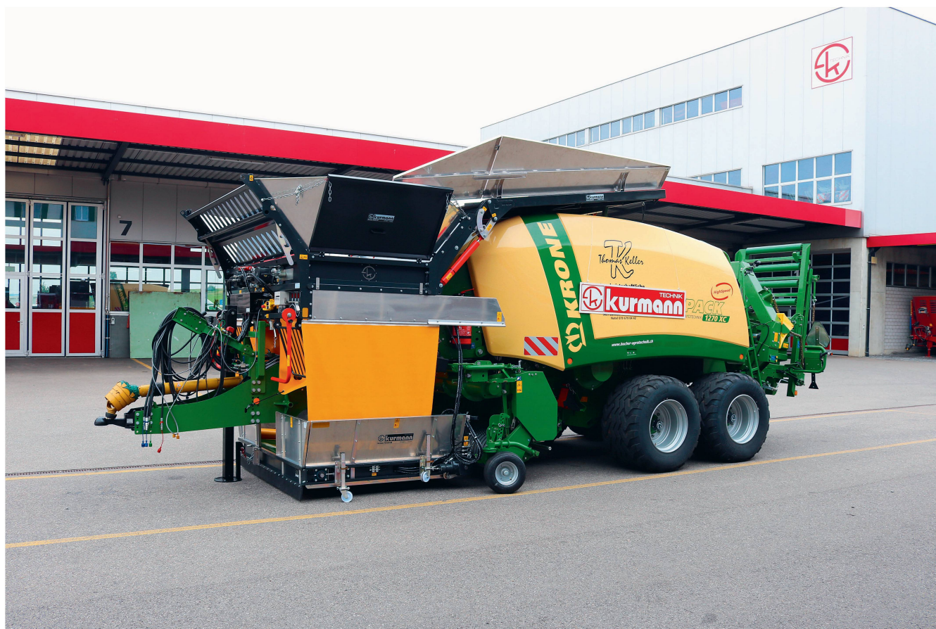
Avec sa table repliable, le doseur «QB Modell 19» offre une surface de réception appréciable. Photos: Ruedi Burkhalter et Kurmann
