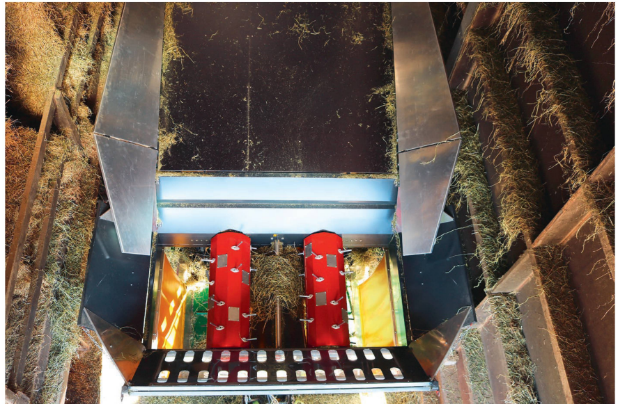
Le fourrage qui descend de la table inclinée est repris et dosé progressivement par les deux rotors munis de dents orientables.
