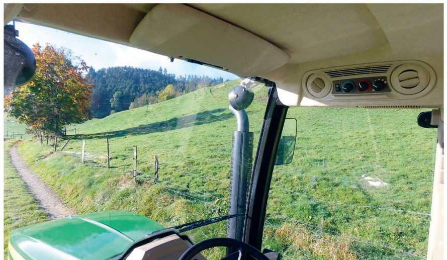
Le pare-brise est incurvé jusque dans le toit, offrant une large visibilité vers le haut et beaucoup de lumière dans l'habitacle.
