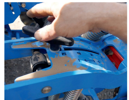
La pression de terrage se règle facilement, au moyen d'un levier. Elle peut atteindre des valeurs comprises entre 148 et 240 kilos.
