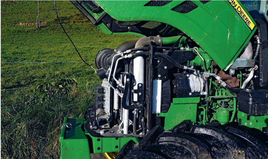
Pour la maintenance, l'accès au moteur est aisé, même si les radiateurs ne peuvent pas se déployer pour le nettoyage.
