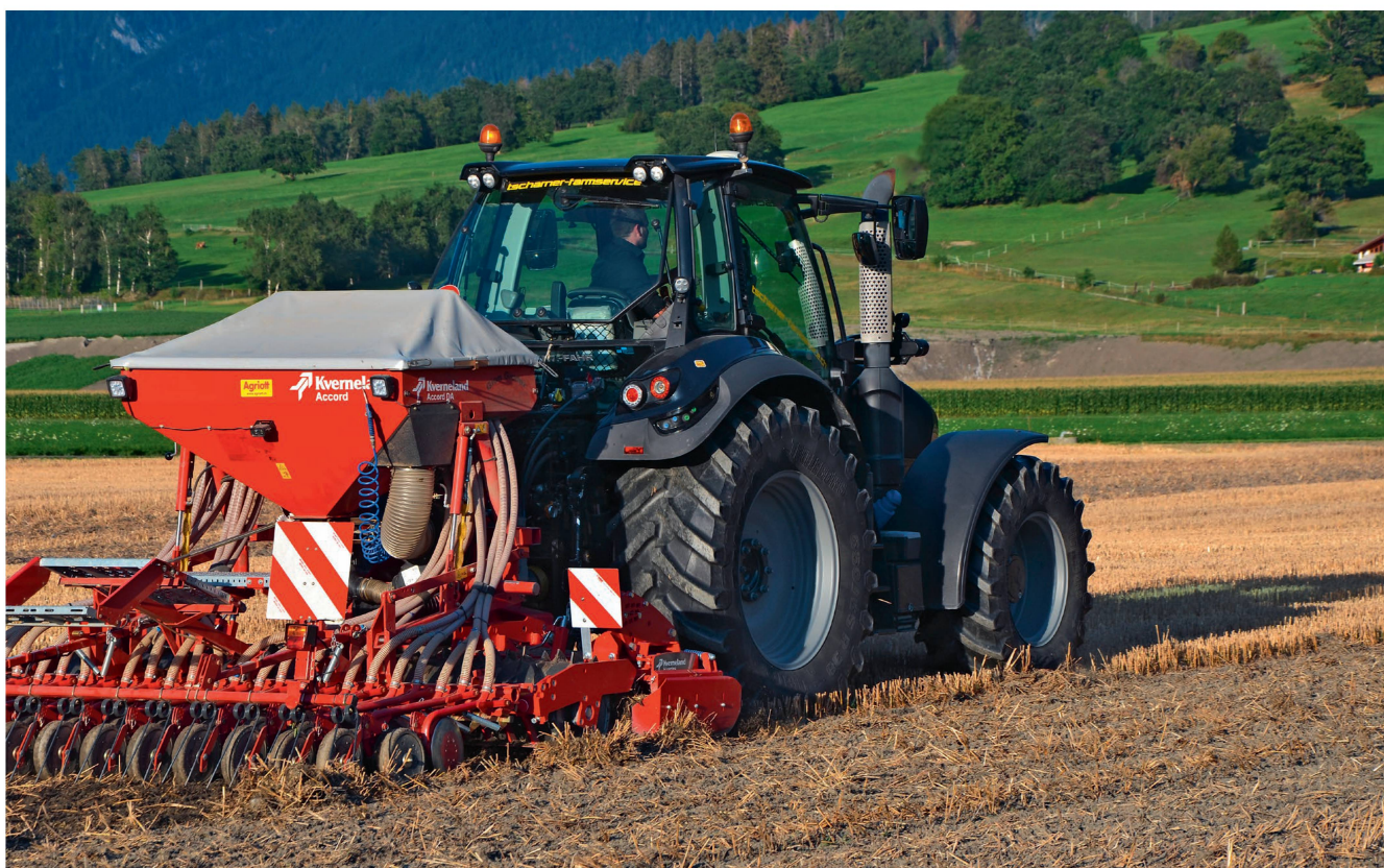
En Suisse, environ 70 % des cultures sont mises en place avec des semoirs associés à des outils de travail du sol, des combinaisons de 3 mètres de large. Photo : Ruedi Hunger
