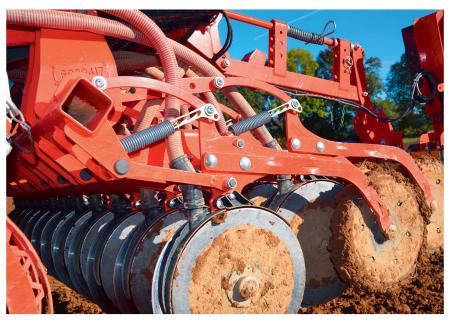
Soc à simple ou double disque? L'influence du sol est plus déterminante que l'option du fabricant. Photo: Ruedi Hunger
