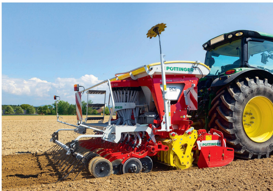
Une ou plusieurs têtes de distribution ? L'espace disponible et la longueur des tuyaux de transport s'avèrent décisifs. Photo : Pöttinger
