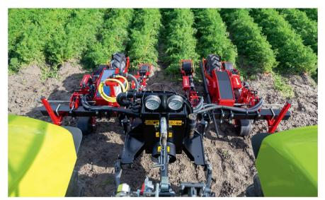
La largeur de travail de ce semoir monograine classique pour les légumes s'aligne sur la zone comprise entre les roues du tracteur. Photo: Stanhay
