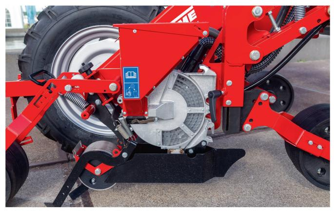
Ce dispositif peut semer des graines de 1 à 10 millimètres de diamètre avec précision jusqu'à quatre lignes. Photo: Grimme
