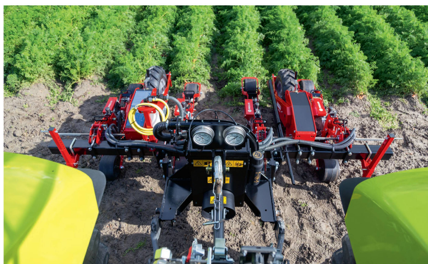
La largeur de travail de ce semoir monograinne classique pour les légumes s'aligne sur la zone comprise entre les roues du tracteur. Photo : Stanhay
