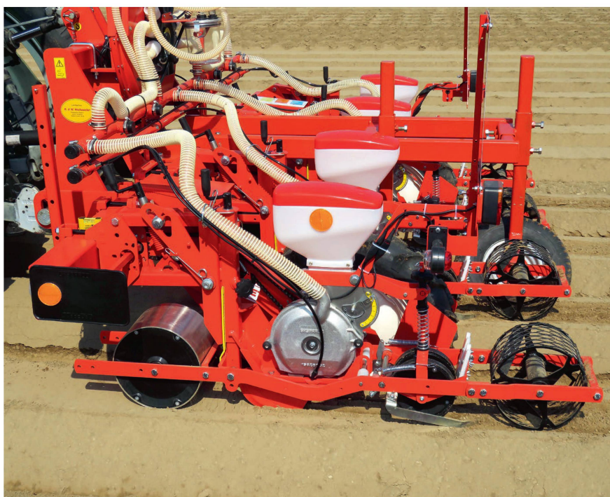
L'élément semeur à parallélogramme est particulièrement conçu pour le semis délicat des graines de légumes. Photo : Gaspardo/Maschio
