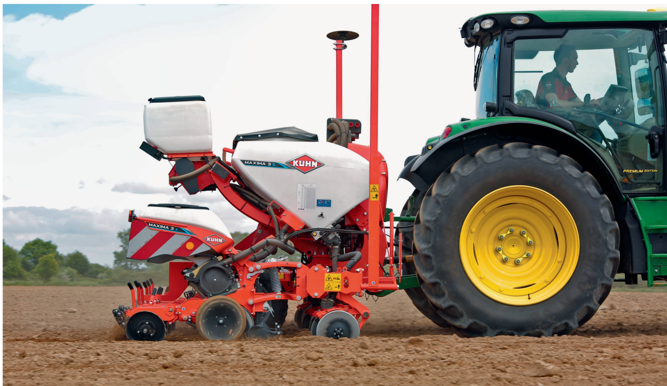
Les engrais minéraux seront toujours plus souvent mis en place directement dans le sol au moment du semis. (Kuhn «Maxima» avec équipement pour la distribution d'engrais.) Photo: Kuhn
