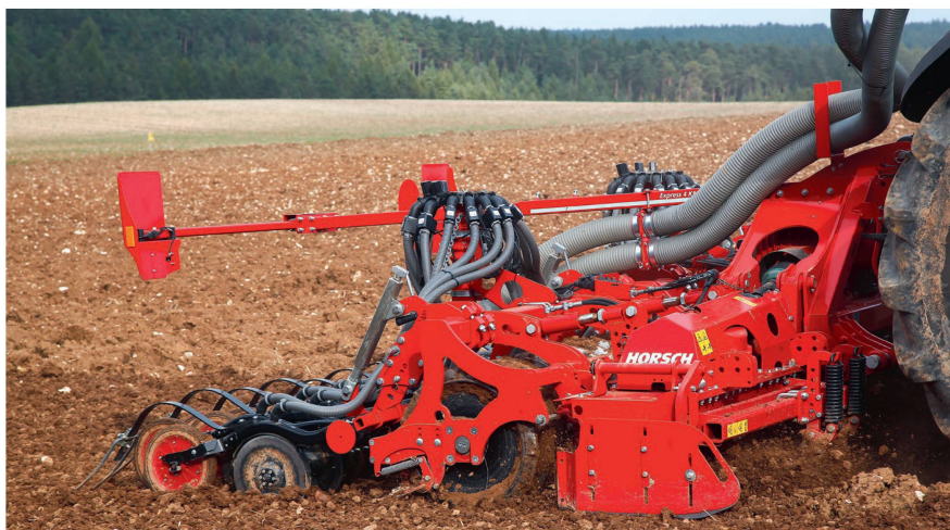
Une répartition plus homogène des semences doit permettre à chaque plante d'avoir les mêmes ressources à disposition (par exemple le semis monograine de céréales par le « Singular System » de Horsch). Photo : Horsch
