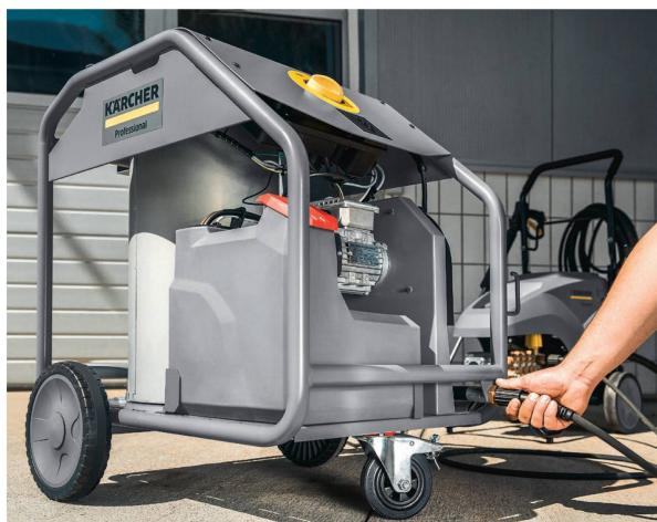
La livraison inclut également un pistolet résistant à l'eau chaude. En fonction de l'appareil haute-pression utilisé, il suffit de choisir les buses correspondantes et un combiné à eau chaude extrêmement flexible est prêt à l'emploi.
