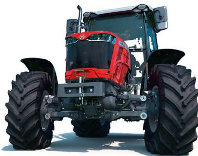
La nouvelle suspension de l'essieu avant, que Massey Ferguson introduit en option sur les tracteurs de la gamme « **MF 3700 AL** », est désormais en vente. Elle apporte un plus en matière de confort, de traction et de maniabilité. L'essieu avant suspendu est proposé pour tous les modèles de 75, 85 et 95 chevaux dotés de cabines stan-
