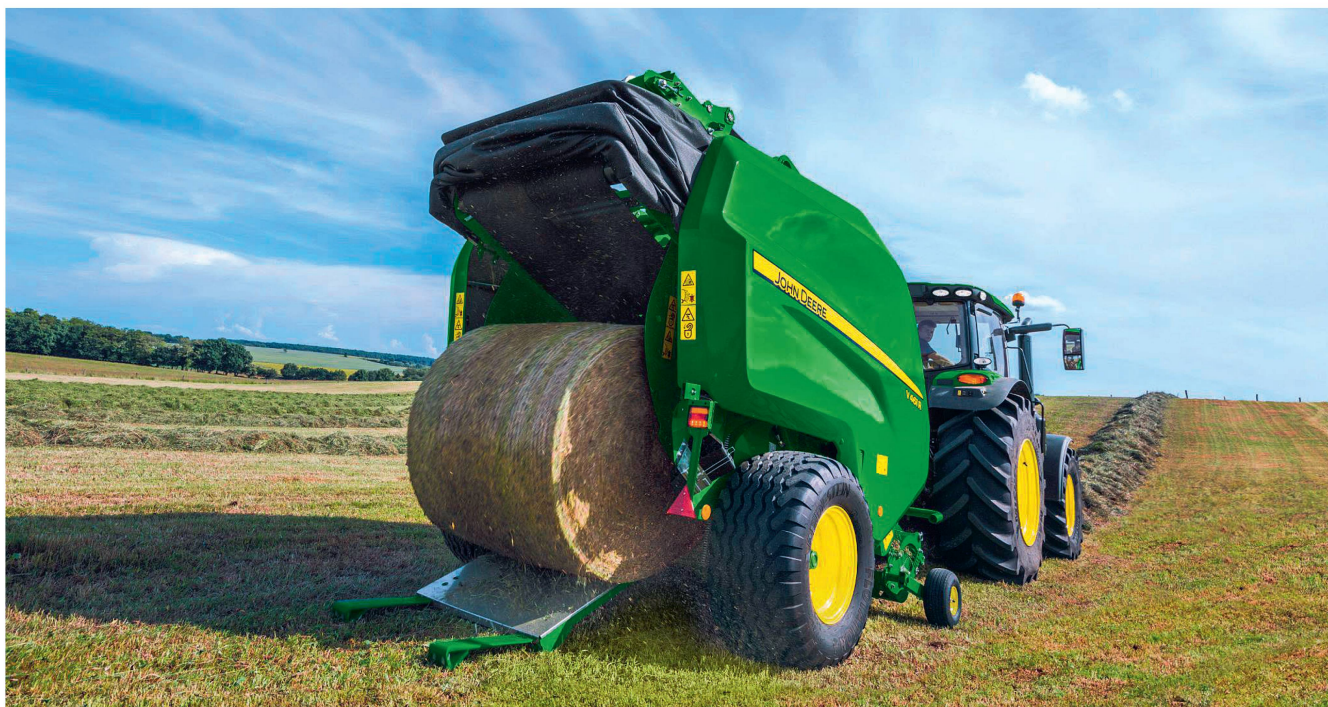
La «V461R» éjecte la balle en moins de cinq secondes, puis le rideau se referme. Photo: JD
