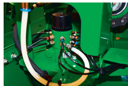
La lubrification se fait automatiquement, par exemple à chaque ouverture du hayon. Photo : Ruedi Hunger
