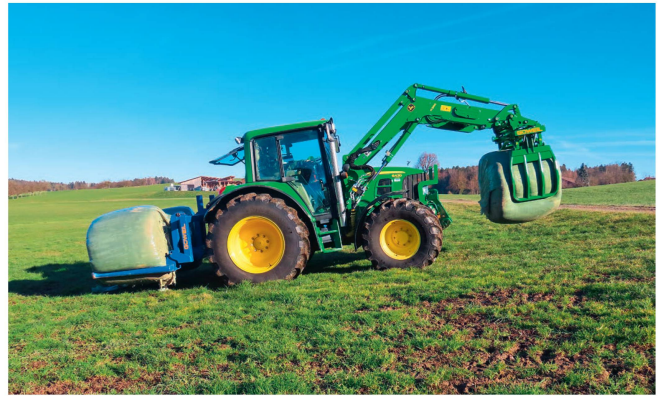
Dans l'essai, le tracteur était chargé de trois balles d'ensilage de 900 kilos. Deux d'entre elles se trouvaient à l'arrière et la troisième, à l'avant, était transportée par le nouveau bras supérieur.
