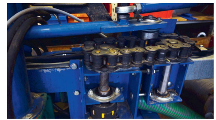
Le mouvement alternatif des bras est généré par un solide ensemble chaîne-pignons.
