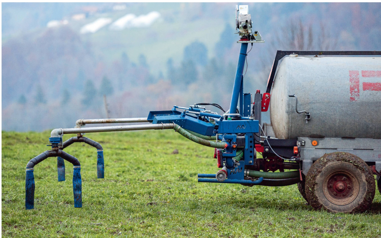
L'épandeur à pendillards Mai s'adapte à la majorité des citernes à lisier. Photos: Ruedi Burkhalter
