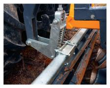
Sur le rouleau quadruple «Double Cutting Master», les rouleaux à couteaux peuvent recevoir une pré-tension manuelle au moyen d'un ressort.
