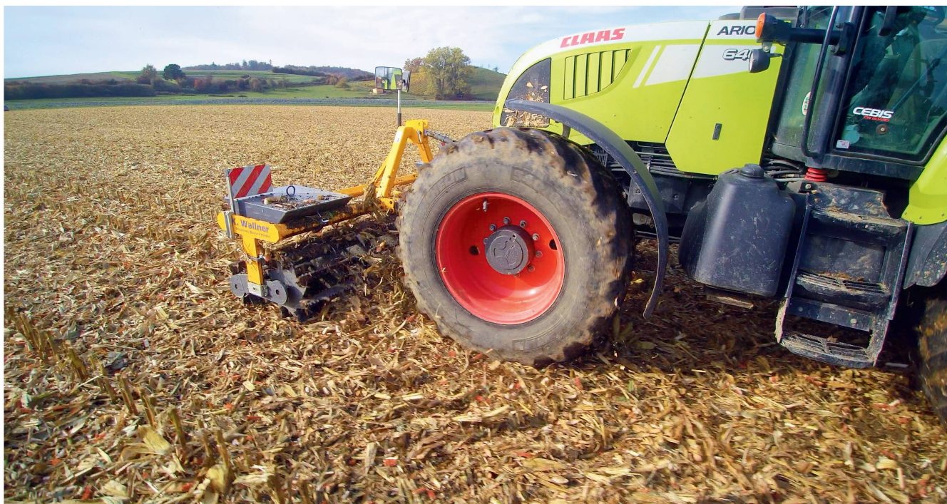
Le rouleau à couteaux tandem conçu pour l'attelage frontal, ici lesté par 260 kilos et équipé de lames lisses à l'avant et dentées à l'arrière, travaille de manière optimale cet engrais vert. Photos : Roman Engeler
