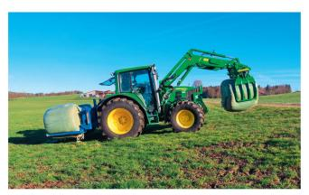
Dans l'essai, le tracteur était chargé de trois balles d'ensilage de 900 kilos. Deux d'entre elles se trouvaient à l'arrière et la troisième, à l'avant, était transportée par le nouveau bras supérieur.
