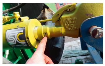
La pression peut être ajustée entre 20 et 110 bars dans un atelier spécialisé. Le mécanisme de suspension est entièrement intégré dans la tige de piston de 60 millimètres d'épaisseur.
