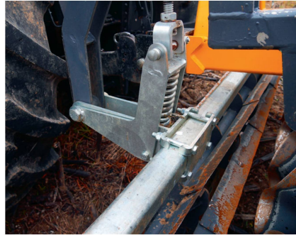
Sur le rouleau quadruple «Double Cutting Master», les rouleaux à couteaux peuvent recevoir une pré-tension manuelle au moyen d'un ressort.
