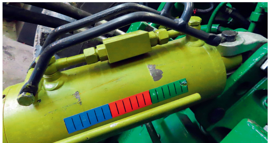
La barre de maintien incurvée sert en outre de protection pour le boulon d'ancrage et le bloc de verrouillage sur le cylindre.
