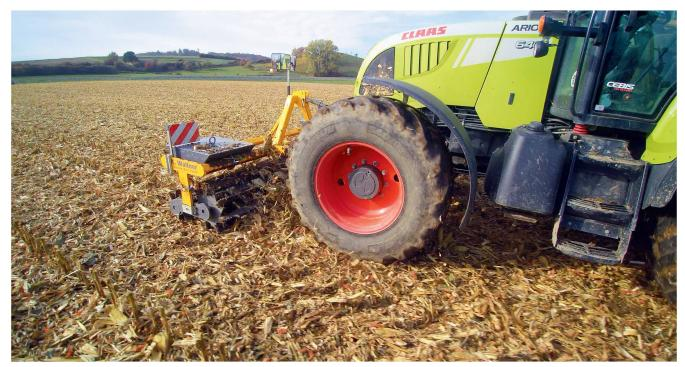
Le rouleau à couteaux tandem conçu pour l'attelage frontal, ici lesté par 260 kilos et équipé de lames lisses à l'avant et dentées à l'arrière, travaille de manière optimale cet engrais vert. Photos: Roman Engeler
