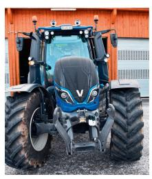
L'essieu avant est à suspension pneumatique, freins multidisques en bout de transmission, et il est dimensionné pour accueillir des contrepoids supplémentaires.
