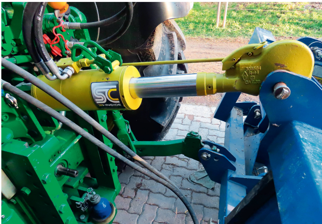
Le puissant bras supérieur développe 12 tonnes de traction et plus de 17 tonnes de poussée. Son débattement de 30 millimètres amortit les fortes sollicitations. Photos: Martin Abderhalden
