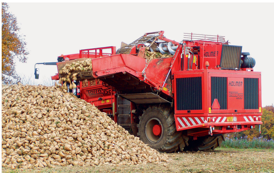
Lorsqu'elles reculent, les grandes récolteuses émettent des signaux sonores permanents ou situationnels, sous forme de « bips » ou d'émissions continues. Photo: Ruedi Hunger
