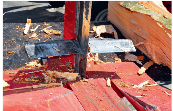
Le coin en croix est un élément central du dispositif des fendeuses horizontales.
