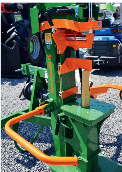
Cette fendeuse verticale convient pour les petites et grosses bûches.
