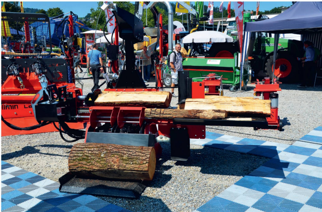
Un dispositif de levage comme un treuil tire-bûche facilite la mise à disposition du bois.
