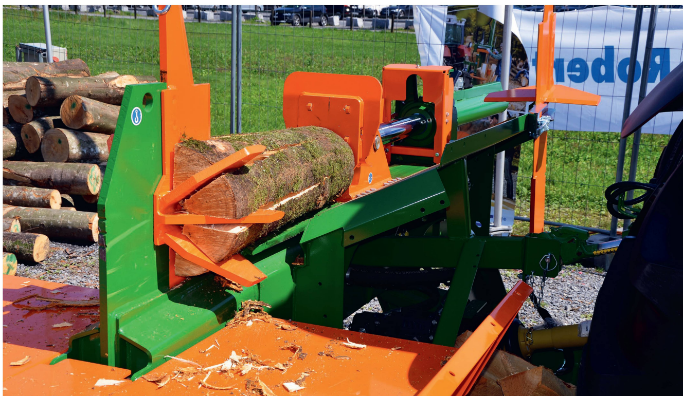
Ce système de fendage produit directement plusieurs bûches. Photos: Ruedi Hunger
