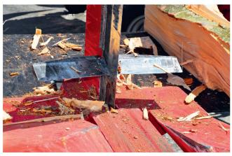
Le coin en croix est un élément central du dispositif des fendeuses horizontales.
