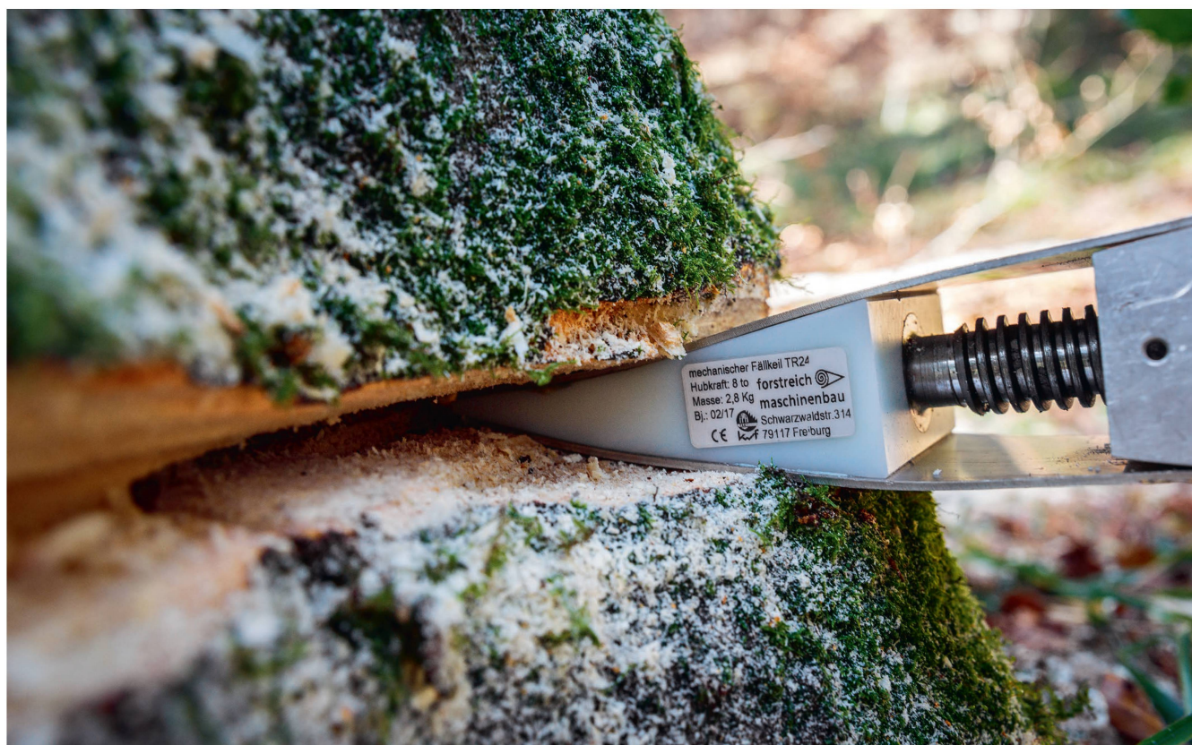
Une aide à l'abattage mécanique remplace le coin traditionnel en aluminium. Photo: ldd
