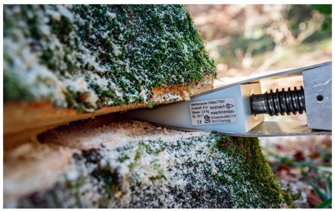
Une aide à l'abattage mécanique remplace le coin traditionnel en aluminium. Photo: Idd
