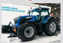
Landini a présenté sa nouvelle gamme «7 Robo-Six» à la Fieragricola, la foire agricole de Vérone (I), du 29 janvier au 2 février. Ces trois tracteurs, de 195 à 225 chevaux, sont conformes à la norme d'émissions 5; ils bénéficient d'un design et d'un toit de cabine revus et corrigés. Landini annonce d'autres innovations: cing boutons configurables sur le levier, la disposition des boutons sur l'accoudoir et des fonctions supplémentaires sur le terminal « DSM » (« Data Screen Manager »).
