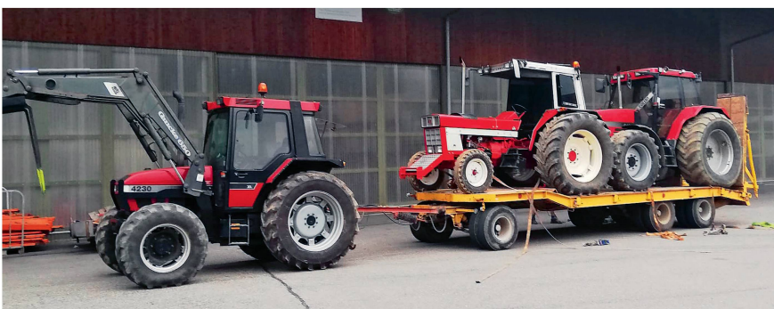
En ordre de marche pour rejoindre le «Tractor Pulling» à Dürnten (ZH): le Case IH «Maxxum 5140» est tout derrière, le «844» avec son turbo ajouté est au centre, et le «4230» emmène l'ensemble sur la remorque surbaissée.
