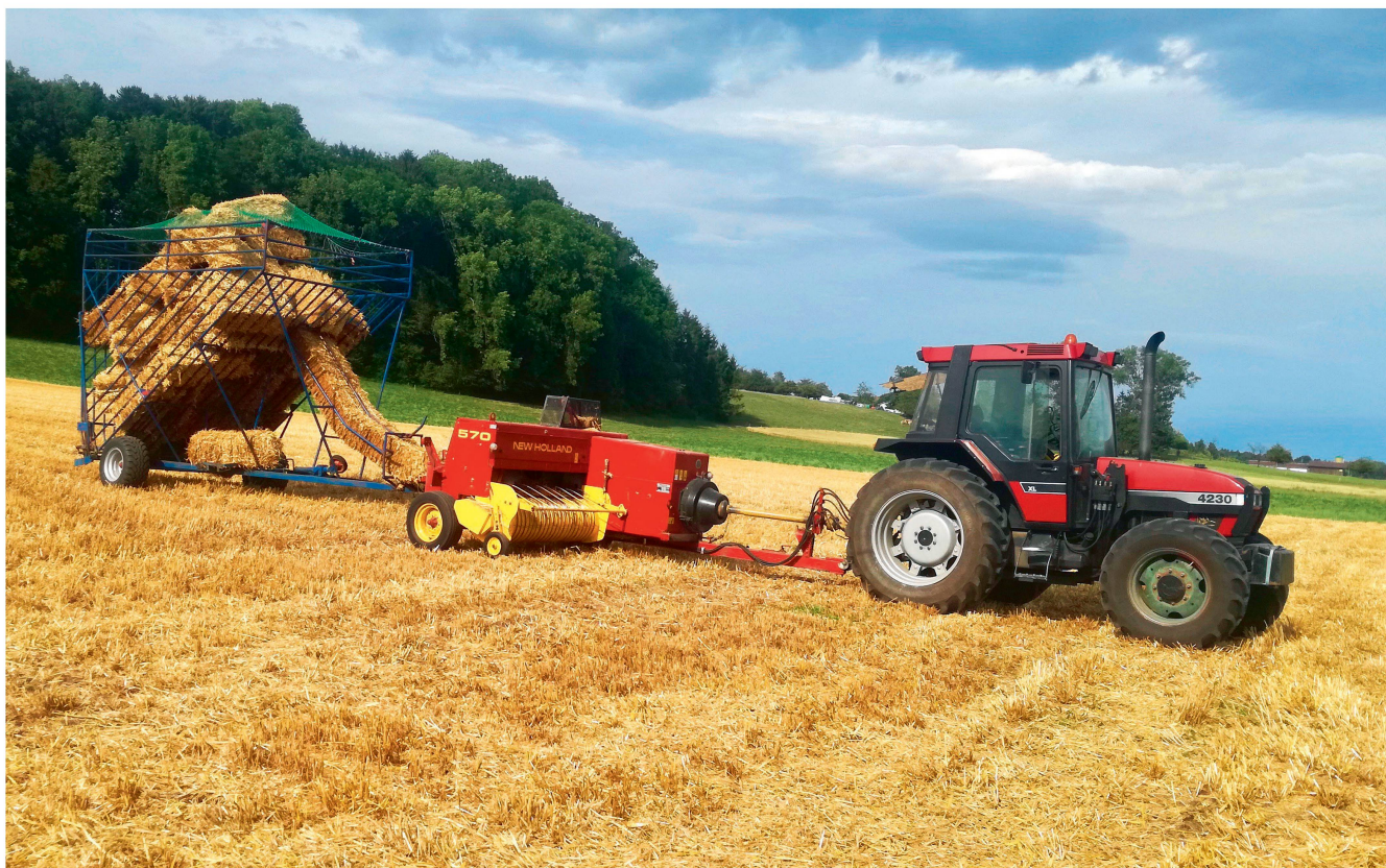
Le Case IH «4230», la botteleuse New Holland «570» et la remorque à bottes construite «maison» forment un bel attelage. La ramasseuse peut charger jusqu'à 70 bottes. Photos: Dominik Senn et Idd
