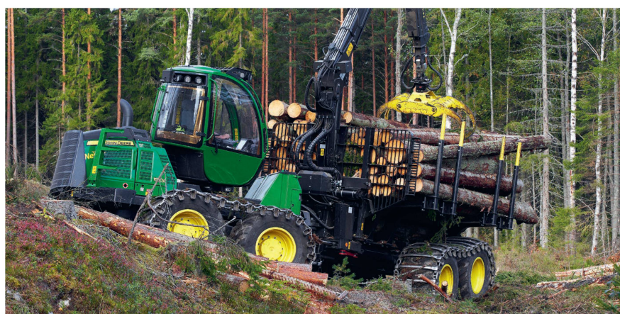
Les systèmes de radar utilisés notamment sur les machines forestières ont un secteur de détection qui peut être séparé en plusieurs zones. Photo : John Deere
