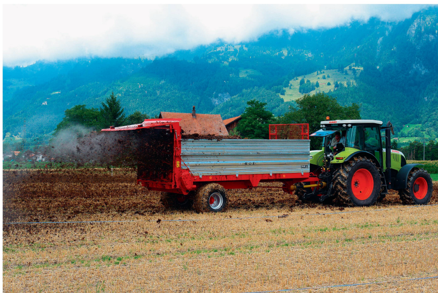
Sur l'épandeur à fumier standard, les lampes sont montées sur le hayon, mais se salissent malgré tout.
