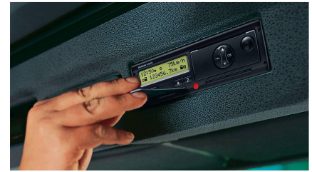
Les tracteurs autorisés à rouler à plus de 40 km/h doivent être équipés d'un tachygraphe numérique.
