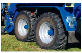
La presse-enrubanneuse combinée est chaussée en série d'imposants pneumatiques Vredestein « Flotation Trac » de taille 560/45 R22.5.
