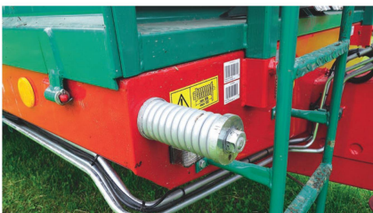
La tension des chaînes du tapis est facile à contrôler et à régler grâce aux ressorts de compression placés à l'avant du châssis.
