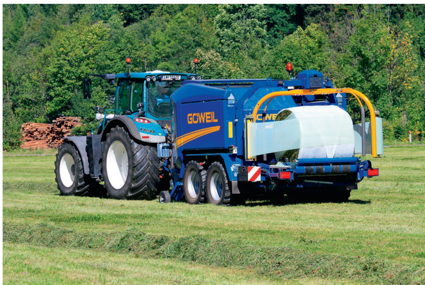
De construction robuste, la presse-enrubanneuse combinée Göweil «G1 F125» se distingue par son débit de chantier élevé et ses performances hors-norme en matière de pressage qui permettent de confectionner des balles de qualité exemplaire. Photos : Johannes Paar
