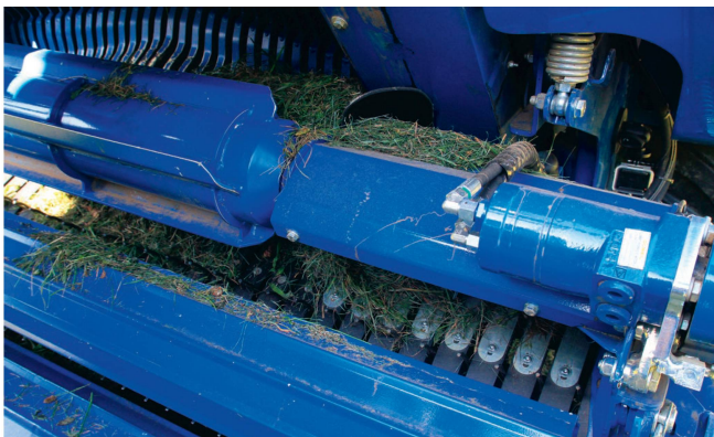
Le rouleau d'alimentation à pales est entraîné mécaniquement. Un moteur hydraulique additionnel intervient en cas de bourrage.
