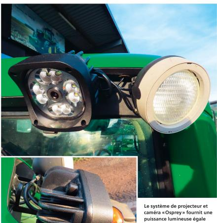
caméra «Osprey» fournit une puissance lumineuse égale à celle de trois projecteurs halogènes de 55 watts. Les ailettes profondes de son boîtier assurent un refroidissement efficace.
