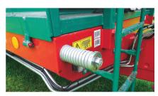
La tension des chaînes du tapis est facile à contrôler et à régler grâce aux ressorts de compression placés à l'avant du châssis.
