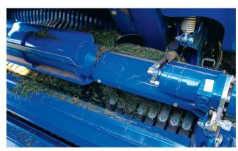
Le rouleau d'alimentation à pales est entraîné mécaniquement. Un moteur hydraulique additionnel intervient en cas de bourrage.
