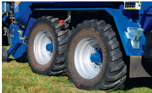
La presse-enrubanneuse combinée est chaussée en série d'imposants pneumatiques Vredestein « Flotation Trac » de taille 560/45 R22.5.
