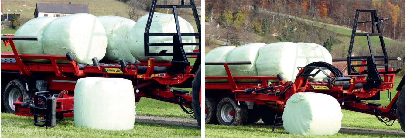
La pince étant pivotante, elle peut saisir aussi bien des balles couchées que dressées.
