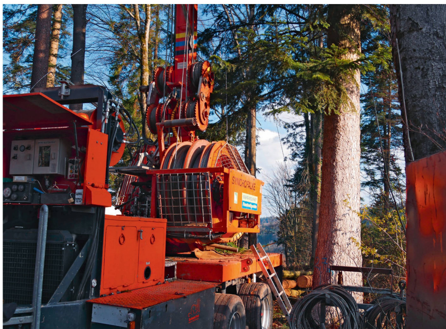
Les tambours de la station de tête dans lesquels le câble de traction et le câble de rappel sont enroulés chacun dans un sens. Photo : Roman Engeler
