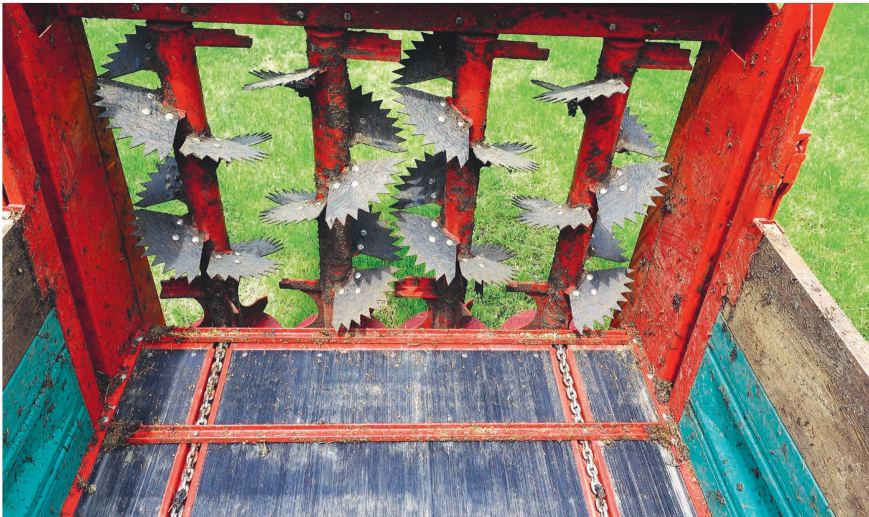
Boulonnées, les pales dentées en Hardox sont faciles à remplacer.
