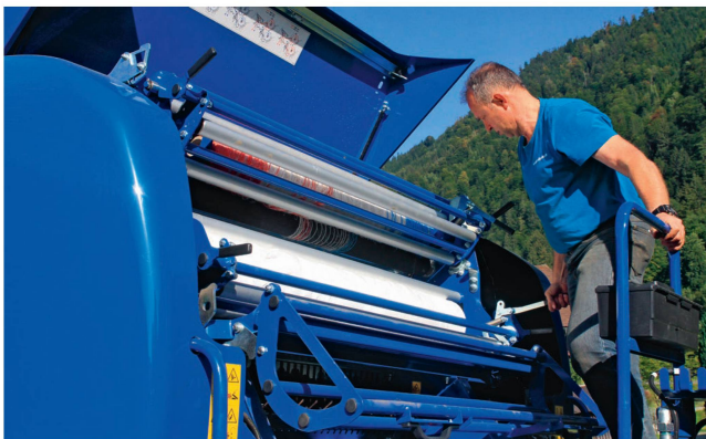
Un aspect très remarquable de la Göweil : le système filet-film de liage qui permet de réduire de moitié le temps de liage.
