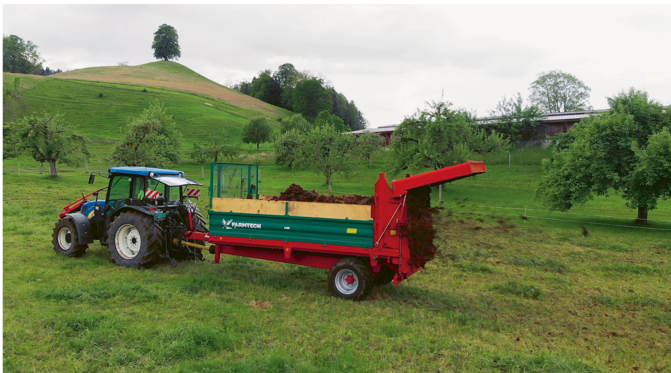
Pulvérisant finement le fumier sur une grande largeur, le « Superfex 700 » convient bien à l'épandage sur prairies. Photos: Ruedi Burkhalter
