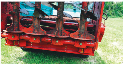
Le niveau d'huile des renvois d'angle est visible en tout temps grâce aux regards transparents.
