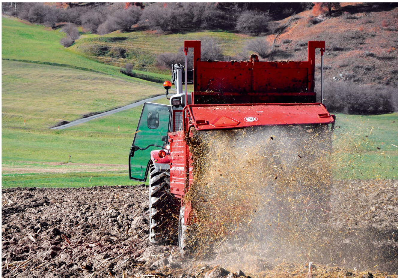
Les deux tiers de la puissance requise pour un épandeur de fumier sont imputables au dispositif d'épandage. Photo: Ruedi Hunger
