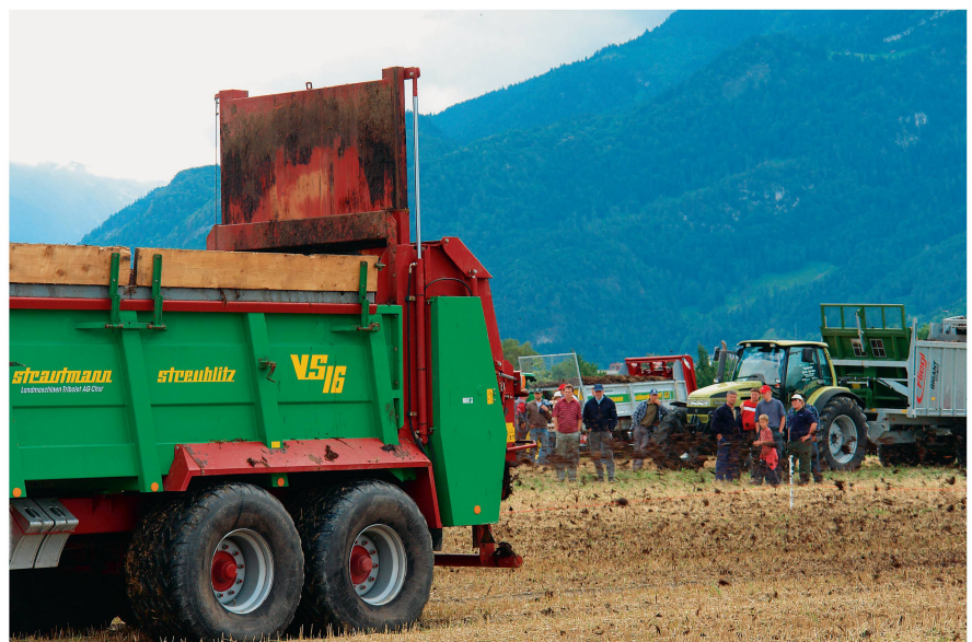
Le châssis détermine la charge utile et le confort du conducteur, la charge au sol dépend de la qualité des pneus. Photo: K. Merk
