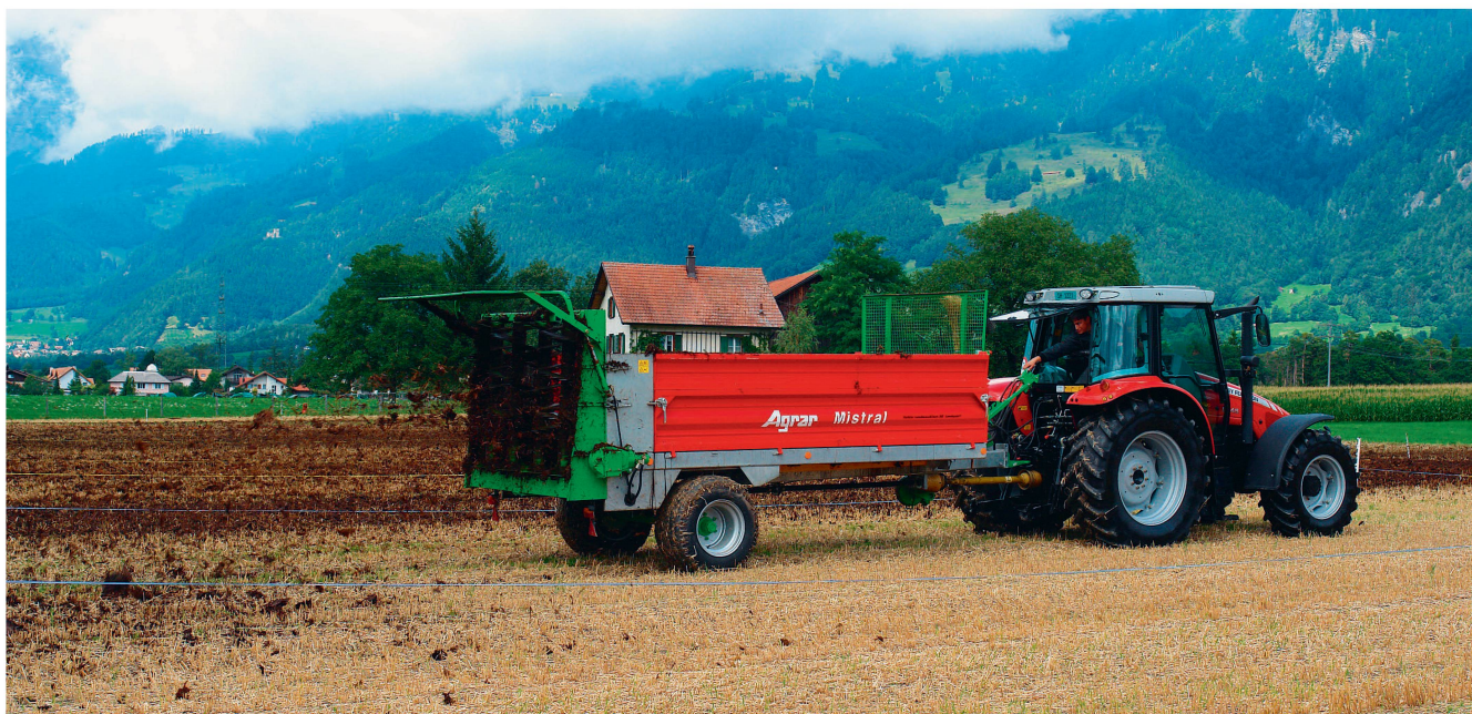
L'«épandeur à fumier standard» pour la mécanisation individuelle dispose de quatre hérissons verticaux. Photo: Ruedi Hunger
