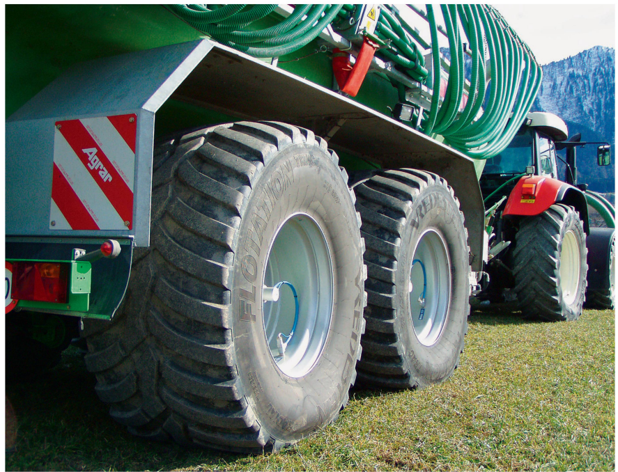
Des pneus grands et larges, avec système de régulation de la pression, constituent actuellement le seul moyen de minimiser la pression au sol.
