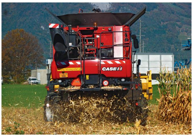
Autour d'une moissonneuse-batteuse, il y a des zones dangereuses. De plus, elle est équipée d'une direction arrière et pivote en porte-àfaux. Il faut donc utiliser des moyens techniques pour pallier au manque de vision. Photos: Ruedi Hunger
