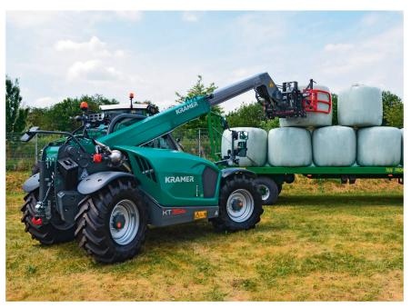
Les zones dangereuses du chargeur télescopique se situent à droite et à l'arrière du véhicule. Des moyens techniques sont aussi nécessaires pour avoir la meilleure visibilité possible.
