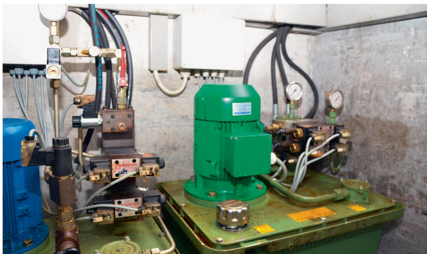
Une filtration supplémentaire peut augmenter la durée d'utilisation de l'huile hydraulique.
