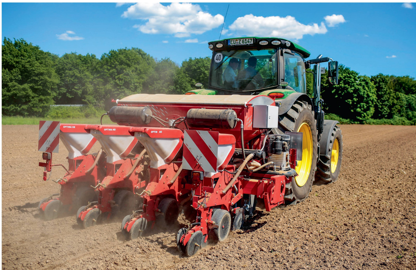
En coopération avec la société Kverneland, l'université technique de Cologne a développé une nouvelle unité de fractionnement conçue pour un semoir monograine conventionnel. Photos : université technique de Cologne
