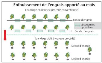
Lors de l'enfouissement de la fumure (en haut), une bande d'engrais continue est déployée. L'application ciblée consiste à donner de l'engrais à chaque graine pendant qu'on la dépose dans le sol.
