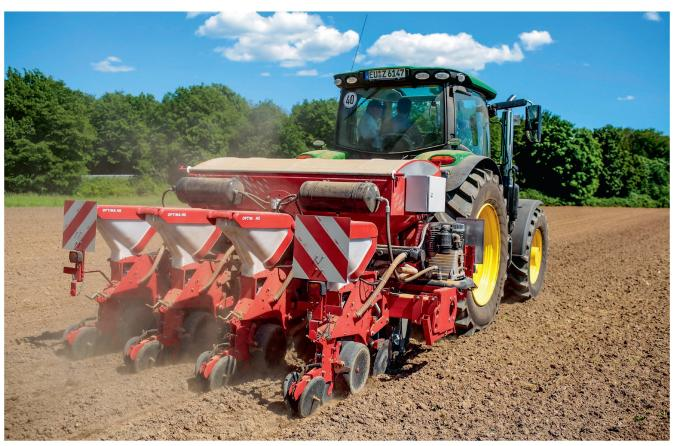
En coopération avec la société Kverneland, l'université technique de Cologne a développé une nouvelle unité de fractionnement conçue pour un semoir monograine conventionnel. Photos: université technique de Cologne
