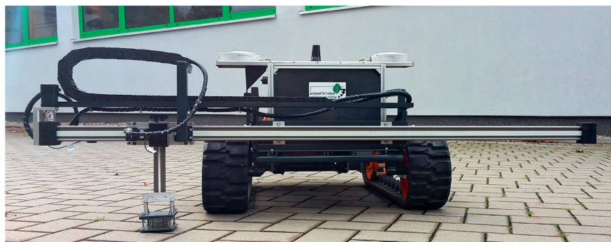
Dès que les limaces sont localisées, le bras articulé positionne la matrice à clous.
