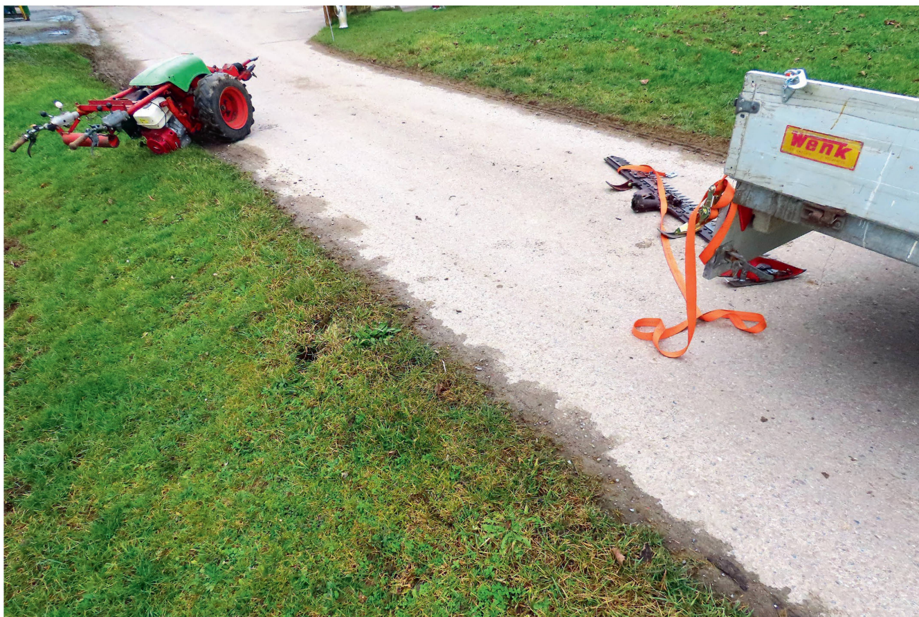
La faucheuse a été «perdue» parce que la barre de coupe s'est détachée du monoaxe. Le conducteur était en train de la fixer à la machine pour pouvoir repartir lorsque la police, déjà avertie, est arrivée. Photo : Martin Abderhalden (scène reconstituée)
