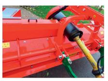
Le point de lubrification du palier du rotor est situé à l'extérieur.
