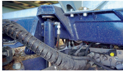
Le train roulant possède un dispositif de correction de dévers automatique et une direction active qui améliore sa maniabilité et le confort d'utilisation.
