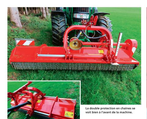
Le dispositif d'attelage offre de nombreuses possibilités de montage et de positions de boulons.
