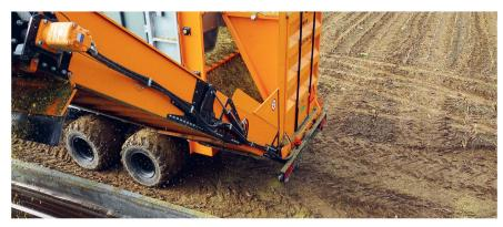
Tous en orange, l'unité de déchargement, ses quatre rouleaux-doseurs et son convoyeurélévateur double repliable ont été conçus et réalisés par Fritz Lehmann.
