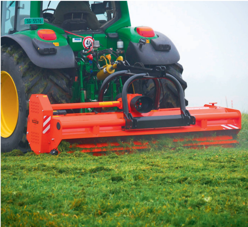
Le « Perfect KR 270 » de Van Wamel, monté ici à l'arrière, peut également se fixer sur le relevage avant.
