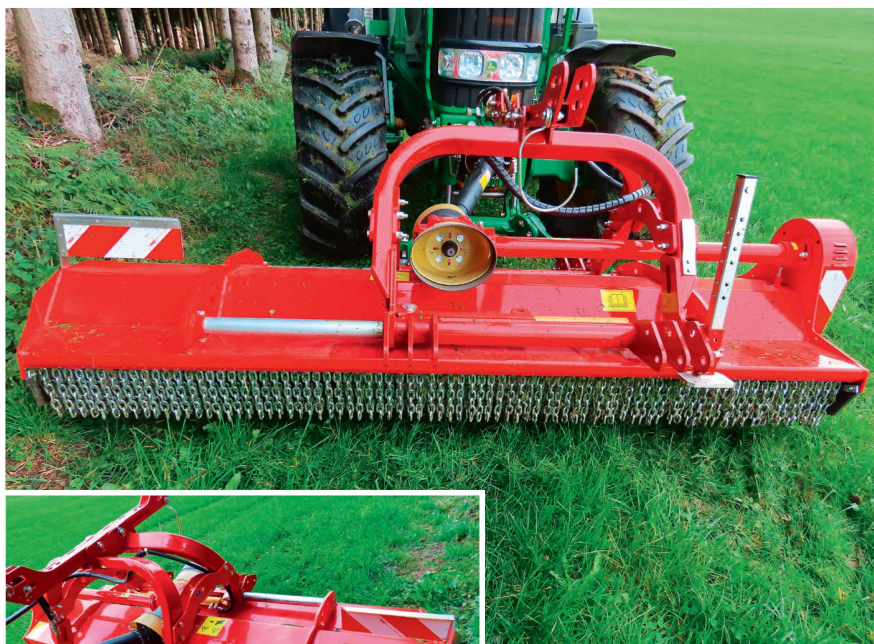
La double protection en chaînes se voit bien à l'avant de la machine.
