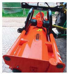
Dispositif d'attelage robuste équipé de grands tubes de renfort.
