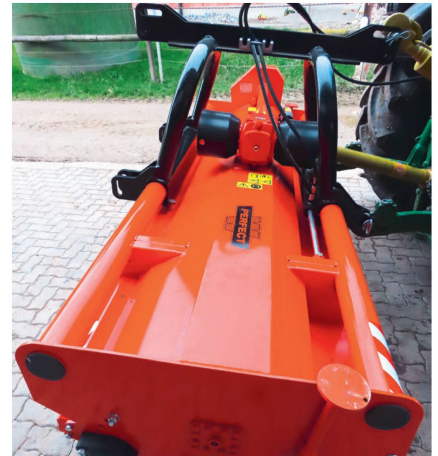
Dispositif d'attelage robuste équipé de grands tubes de renfort.
