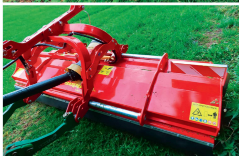
La double protection en chaînes se voit bien à l'avant de la machine.
