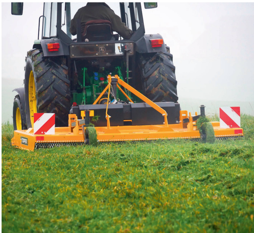
Le carénage du «Topper 9» de McConnel est assez plat. L'attelage trois-points est largement ancré et possède un support de bras supérieur pivotant.
