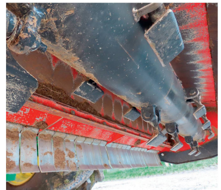
Vue du rotor de grandes dimensions avec ses fléaux disposés en rangs.
