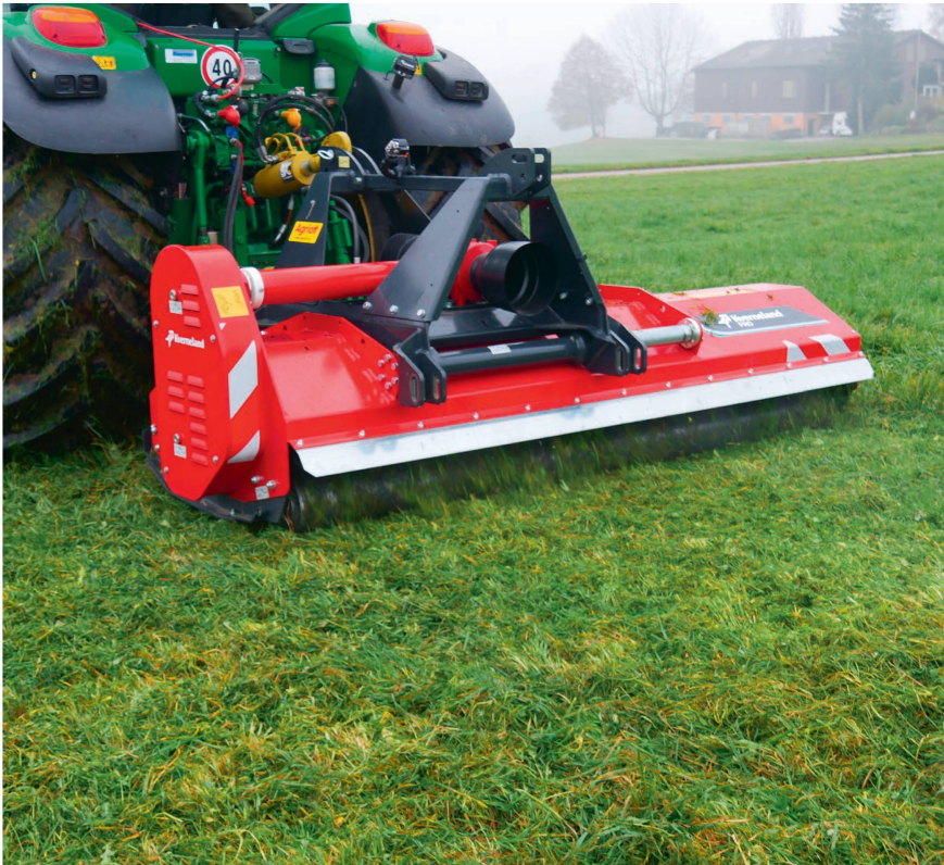
Le Kverneland «FRO 280» était le seul broyeur d'essai équipé de poulies de courroies remplaçables.
