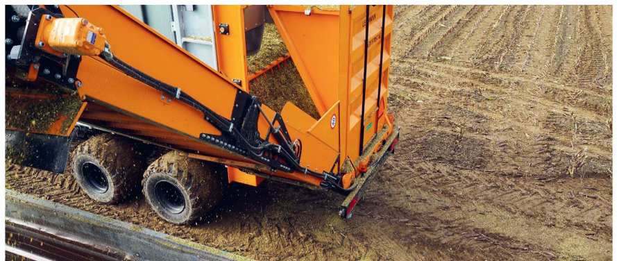
Tous en orange, l'unité de déchargement, ses quatre rouleaux-doseurs et son convoyeur-élévateur double repliable ont été conçus et réalisés par Fritz Lehmann.
