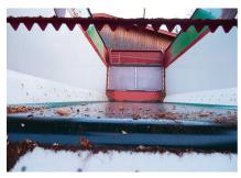
Renforcé de fibres textiles, le tapis mesure 2,10 mètres de large pour 10 millimètres d'épaisseur. Les parois latérales sont composées de panneaux synthétiques renforcés de fibre de verre.
