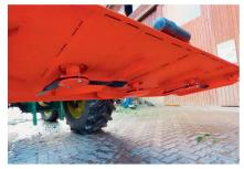
Le broyeur est construit simplement et ne dispose d'aucune protection en chaînes.
