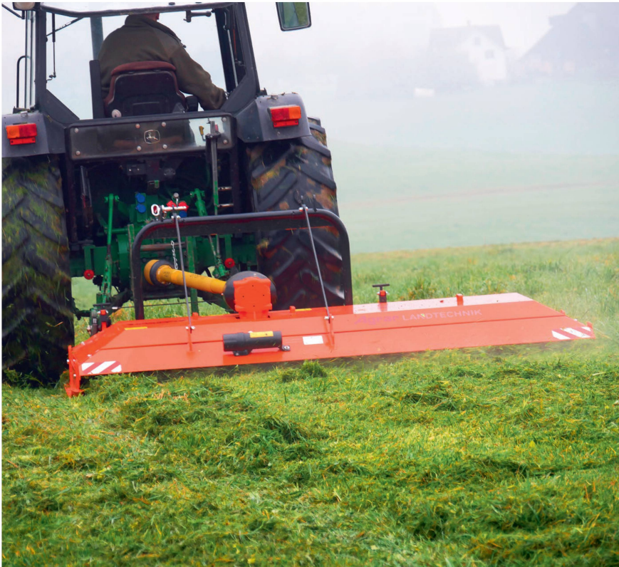
Le déport latéral permet au « Perfect LB 275 V » de Van Wamel de rouler sur la surface à travailler avec une roue seulement.
