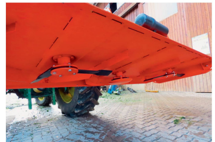
Le broyeur est construit simplement et ne dispose d'aucune protection en chaînes.
