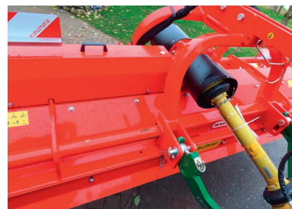
Le point de lubrification du palier du rotor est situé à l'extérieur.
