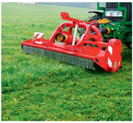
Le broyeur Maschio «Bisonte 280» avec plaque d'usure interchangeable dans la partie supérieure.
