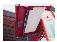
Ce rouleau supplémentaire garni d'un tube spiralé facilite le déchargement des matériaux peu fluides.
