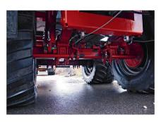
Le train roulant tandem possède un compensateur hydraulique de charge par essieu: il est autodirectionnel.
