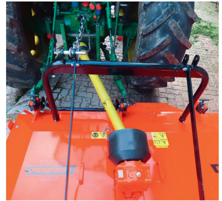
Le système d'attelage rapide des bras inférieurs simplifie le changement de position de montage.
