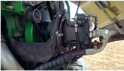
Une pompe supplémentaire a été montée directement sur l'arbre du moteur de l'ensileuse, afin d'assurer une alimentation de toutes les fonctions. Photos : Ruedi Burkhalter
