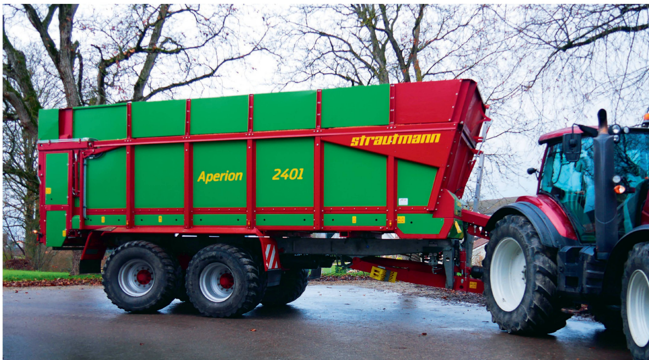
Strautmann utilise une bande (presque) sans fin pour ses remorques à tapis roulant. Photos : Roman Engeler
