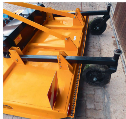
Les roues de jauge pivotent sur 360° et n'ont montré aucun signe de faiblesse.
