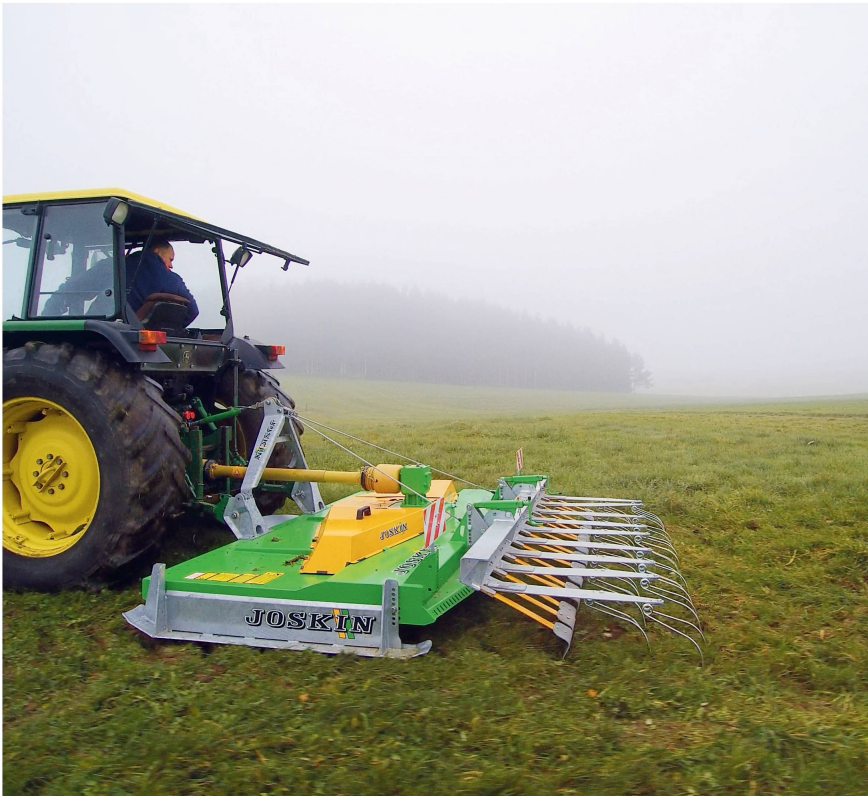
Le broyeur à couteaux « TR 270 C3 » de Joskin était équipé d'un racloir de nivellement et d'un aérateur de prairie.
