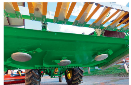
Les trois rotors sont équipés d'une protection contre les obstacles.
