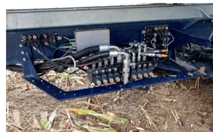
La répartition du flux d'huile disponible entre les différentes fonctions est assurée par un bloc hydraulique du dernier cri intégrant la technologie « flow sharing ».
