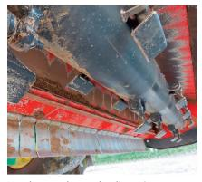
Vue du rotor de grandes dimensions avec ses fléaux disposés en rangs.
