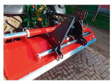
Dispositif d'attelage très robuste avec déport latéral lubrifié et entraînement central.
