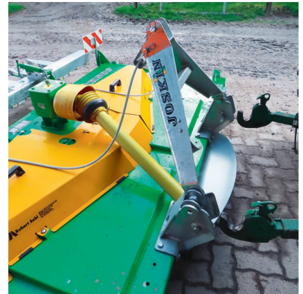
Le dispositif d'attelage oscillant est simple mais pratique.
