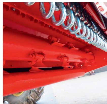
Des fléaux affûtés et deux contre-couteaux assurent un travail propre.
