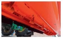
Gros rotor à fléaux disposés en rangs avec contre-couteaux dentelé.
