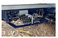
La répartition du flux d'huile disponible entre les différentes fonctions est assurée par un bloc hydraulique du dernier cri intégrant la technologie «flow sharing».
