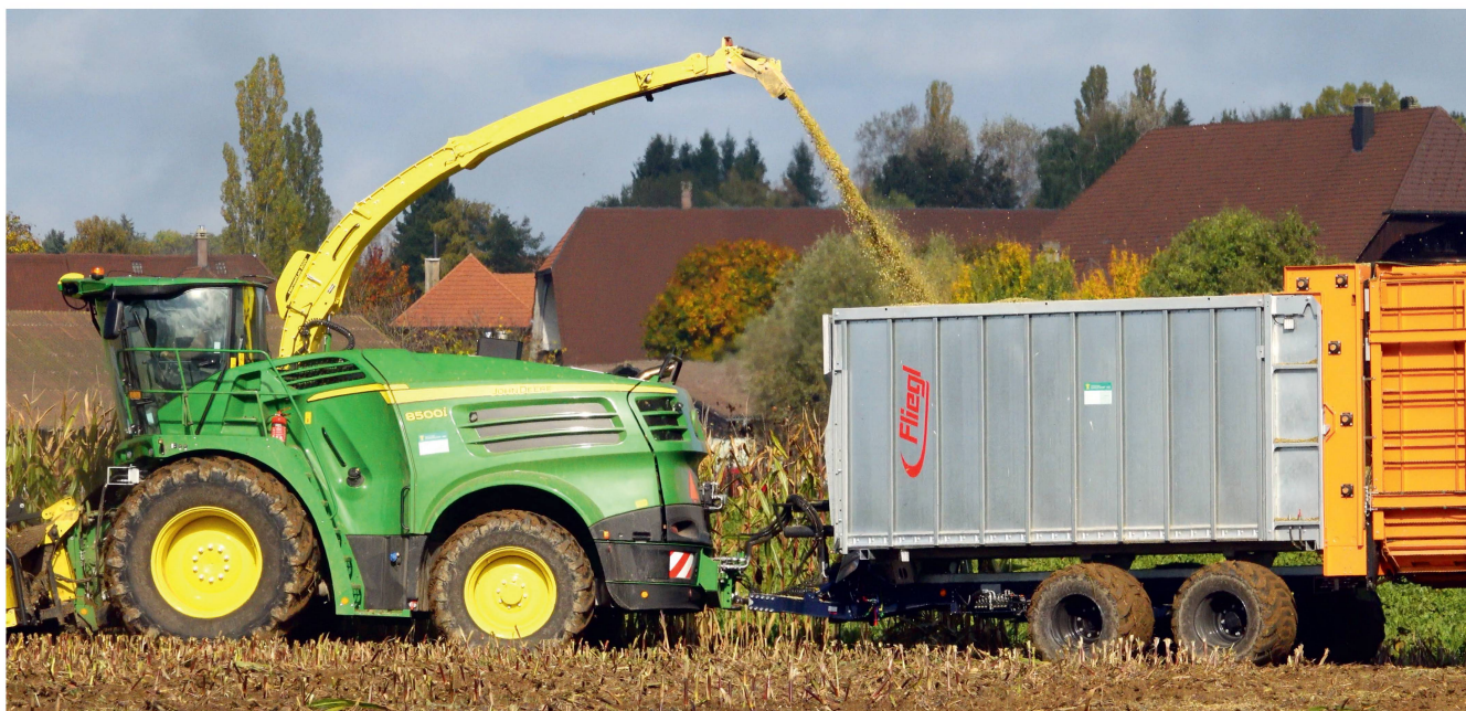
Le caisson est monté sur un châssis à essieu tandem directeur et propulseur à marche en crabe; il est doté d'un élévateur à l'arrière.
