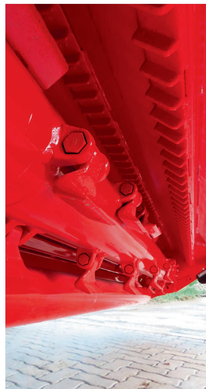
Fléaux en disposition hélicoïdale avec deux contre-couteaux forgés.
