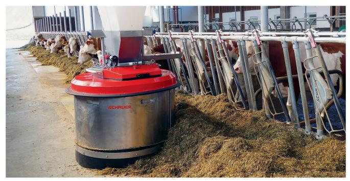
Les pousse-fourrage autonomes réduisent la charge de travail physique et font gagner du temps aux exploitants. Photo: Lely
