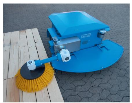
Le robot de nettoyage avec brosse à logettes: il détecte d'abord si elle est libre. Photo: Prinzing
