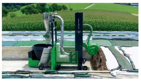
Le système «Lift» de Wasserbauer remplit le robot d'affourragement de manière autonome lorsqu'il se présente dans le silo-tranchée. Photo: Wasserbauer
