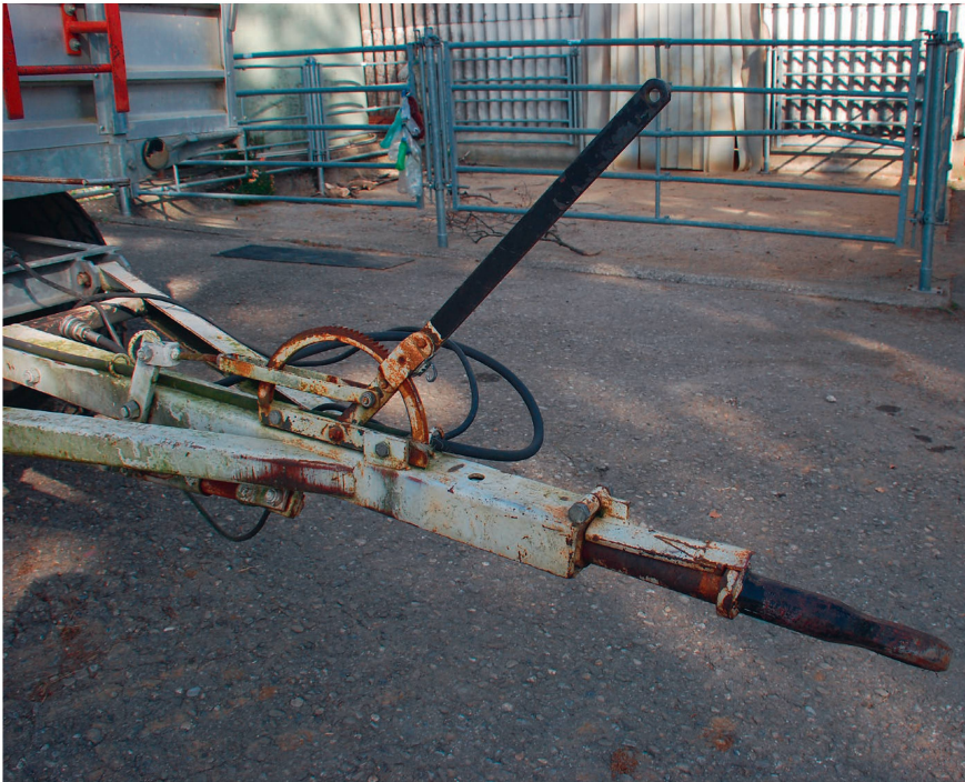
À partir de l'année de construction 1993, le frein Farmerstop n'est autorisé que comme frein de stationnement. L'œillet d'attelage tordu de la remorque présenté sur cette photo est à remplacer. Photo : Heinz Röthlisberger
