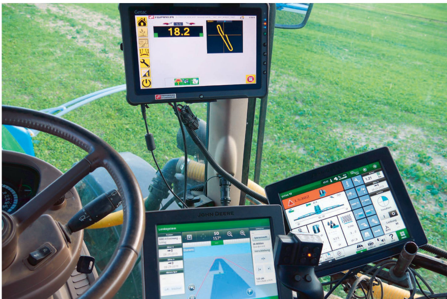
Lorsqu'on installe des écrans dans une cabine de tracteur, il faut prendre garde à ne pas perturber le champ de vision du chauffeur. Photo : Roman Engeler
