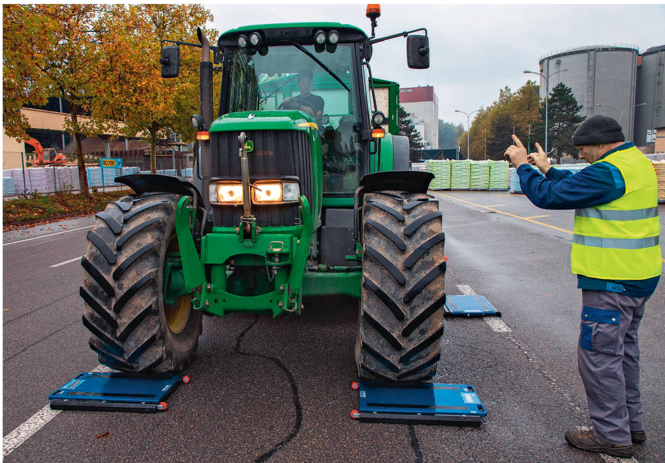
Contrôle de poids à l'aide d'une balance portable. Les véhicules surchargés sont sévèrement sanctionnés en Suisse. Photo: Peter Gerber, gérant de la section bernoise de l'ASETA
