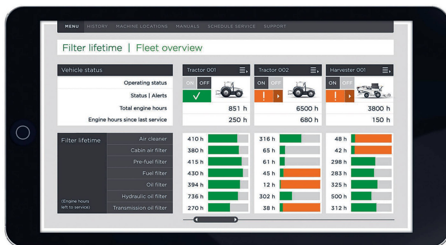
L'interface graphique du tableau de bord propose à l'exploitant un bon aperçu de l'état des filtres de sa flotte de véhicules. Illustrations: Mann+Hummel
