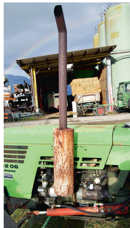
L'échappement sort du même atelier, tout comme l'installation du vérin de direction.
