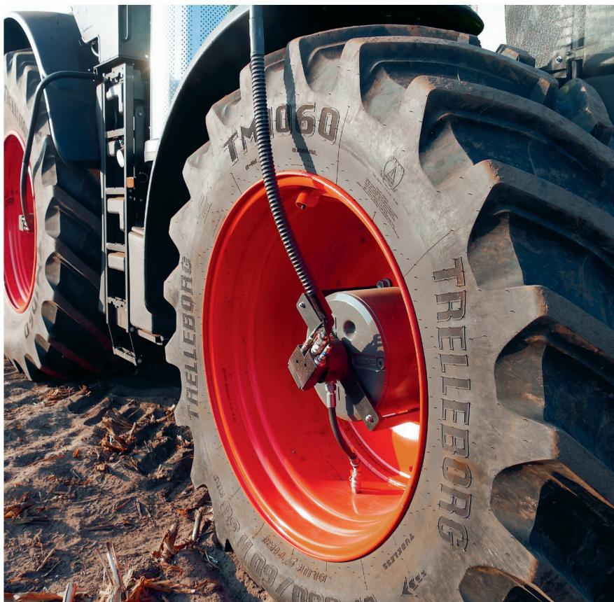
**Si les dispositions relatives aux écarts par rapport aux bords du véhicule ou au flanc des pneus sont respectées et si l'installation est inscrite dans le permis de circulation, on peut rouler sur la voie publique avec des conduites dépassant les contours d'un tracteur.** Photo: Roman Engeler
