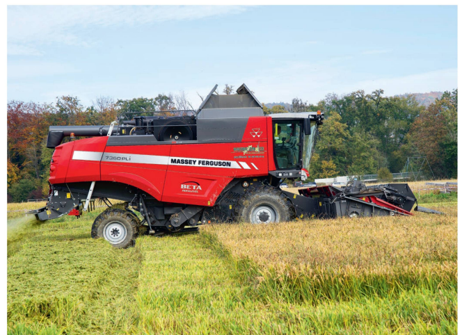
Sur la Massey Ferguson « 7360 Pli », on peut régler électriquement les grilles à lamelles pour les adapter au riz.
