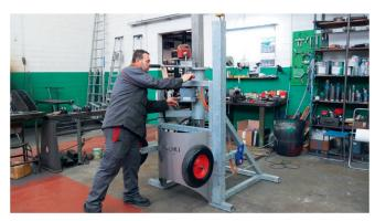
Vue de l'atelier de Brittnau: un brasseur à moteur plongeur est iustement en révision.
