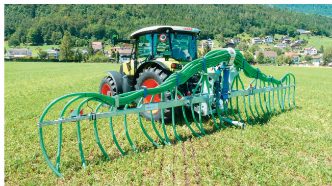
Le pendillard équipé de la tête de répartition «ExaCut» de Vogelsang est une nouveauté de l'entreprise Wälchli.
