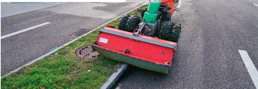
Avec des fléaux allongés (petite photo) l'arbre de la faucheuse-débroussailleuse est plus élevé et n'entre plus en contact avec les bordures.
