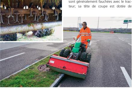
Avec des fléaux allongés (petite photo) l'arbre de la faucheuse-débroussailleuse est plus élevé et n'entre plus en contact avec les bordures.
