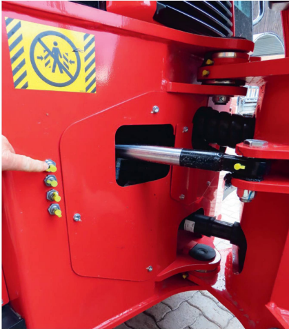
L'articulation est du genre solide-massif. Les points de graissage protégés sont aisément accessibles.
