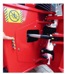
L'articulation est du genre solide-massif. Les points de graissage protégés sont aisément accessibles.
