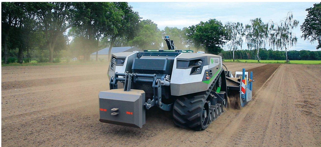
Le robot agricole « Agbot » de la société néerlandaise « AgXeed » est ici en fonctionnement avec une machine à bêcher et un contrepoids sur le relevage avant. Photos: M. Nijenhuis
