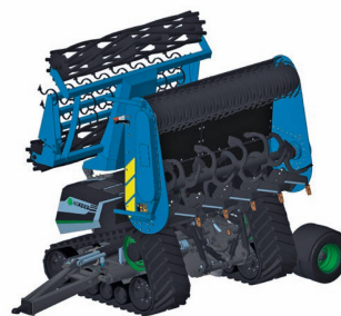
Dessin du robot avec un aperçu de l'essieu et du timon de transport. Photo: AgXeed
