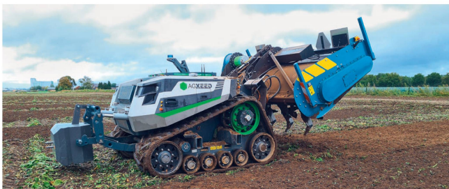
Vue sur le train de roulement à chenilles du robot, qui peut soulever cette bêche modifiée avec son relevage trois-points.
