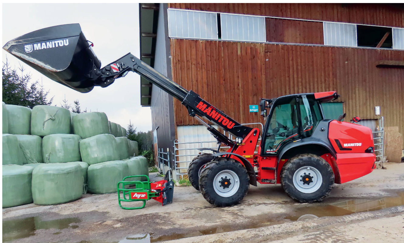
Le chargeur télescopique «MLA-T 533-145V+» pèse 8,5 tonnes à vide, ce qui l'autorise à hisser des charges de 3 tonnes à 5 mètres de hauteur.
