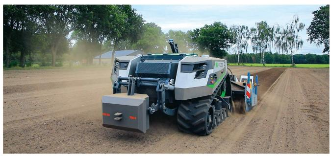
Le robot agricole « Agbot » de la société néerlandaise « AgXeed » est ici en fonctionnement avec une machine à bêcher et un contrepoids sur le relevage avant. Photos: M. Nijenhius
