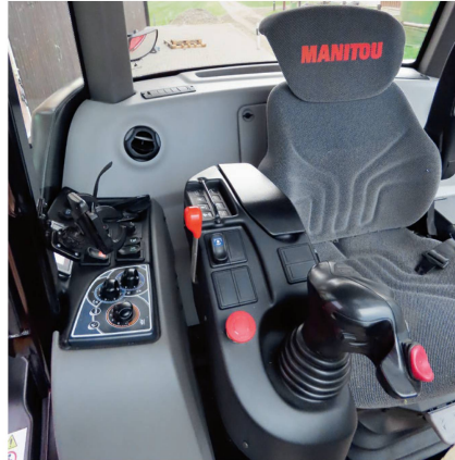
Tous les éléments de commande des fonctions hydrauliques et de pilotage de l'avancement sont rassemblés sur l'accoudoir réglable et sur la console latérale, à droite du siège.
