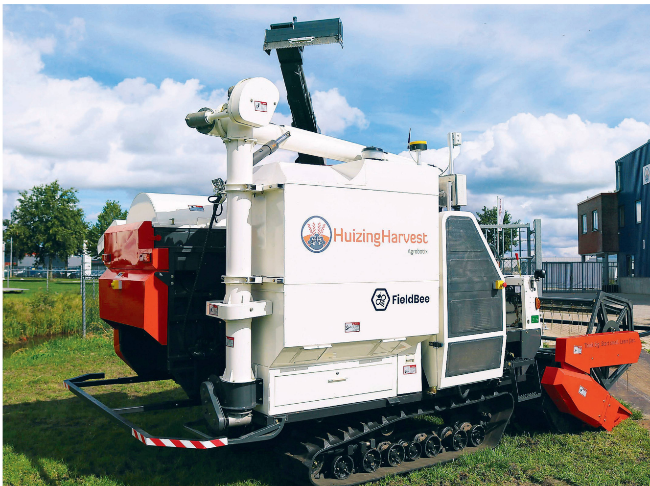
La moissonneuse-batteuse chenillée autonome avec sa barre de coupe de deux mètres et sa trémie à grains de 1000 litres. Photo : Agrobotix
