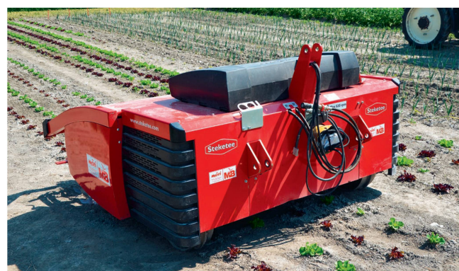
Cet outil porté est également un robot – en l'occurrence un robot de binage. Photo: Ruedi Hunger
