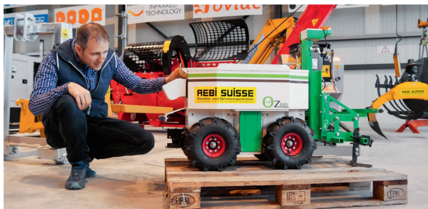
« Oz » est le plus petit des robots de binage proposés par Naïo. Il est désormais équipé d'une antenne GPS qui lui permet de suivre des traces avec précision.
