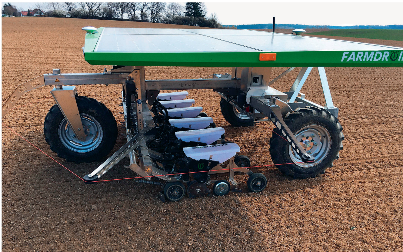
Équipement agricole autonome en action : le robot Farmdroid sème les betteraves à sucre. Photo : ldd
